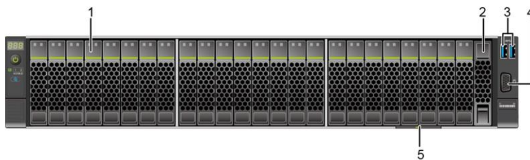
图2-4 24x2.5 SAS/SATA 直通硬盘配置前面板组件
