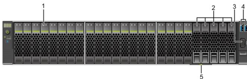
图2-3 8x2.5 SAS/SATA+12x2.5 NVMe 硬盘配置前面板组件
