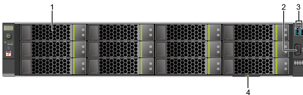
图 3-1 12x3.5 英寸硬盘配置前面板组件
