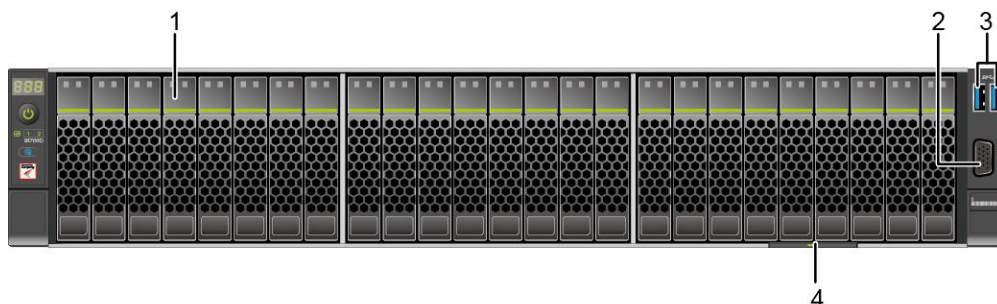
图 3-2 25x2.5 英寸硬盘配置前面板组件
