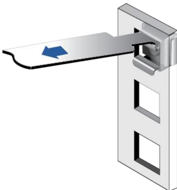
图 6-6 在机柜中安装浮动螺母
