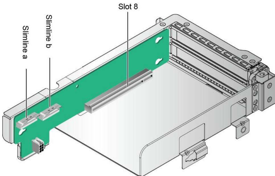
R522 的 PCIe 插槽分布后视图如图 4-23 所示。
