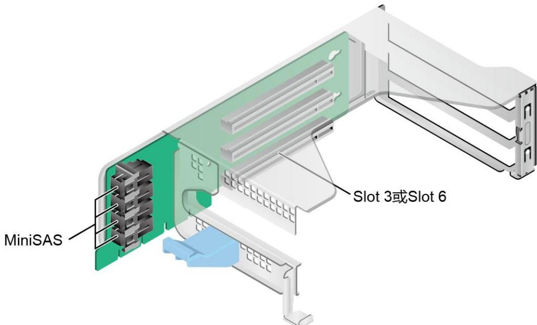
IO 模组 3 支持的 Riser 卡如图 4-21 和图 4-22 所示。
