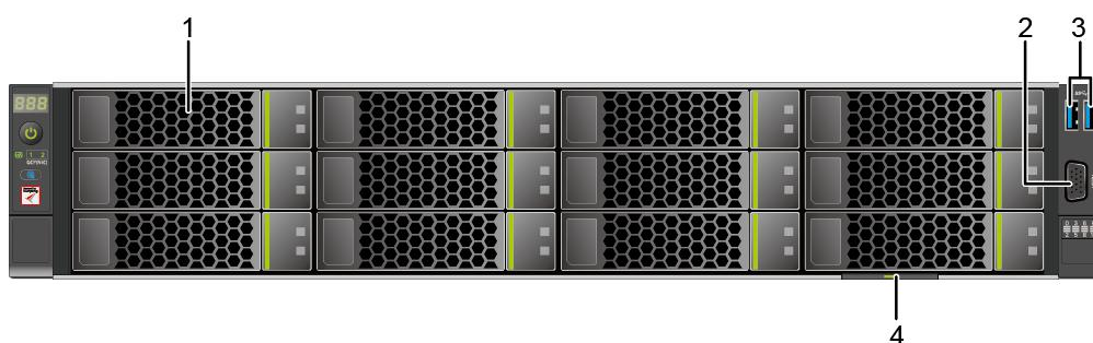
图 4-1 12x3.5 英寸硬盘配置前面板组件
