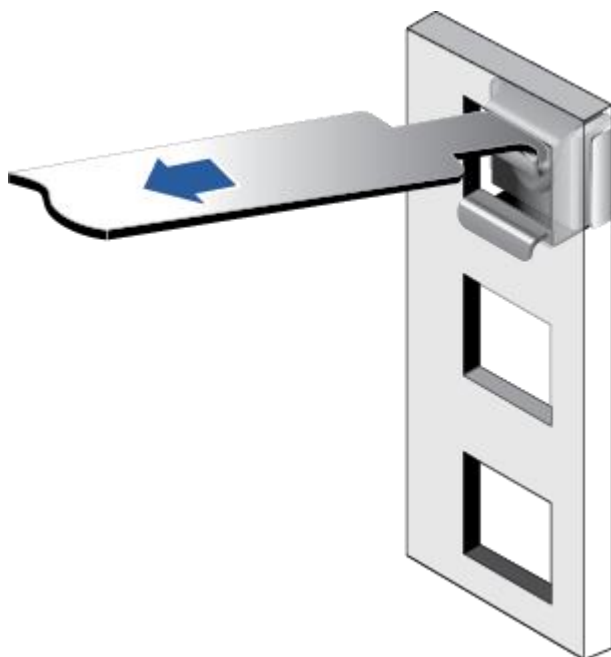
图 6-4 在机柜中安装浮动螺母
