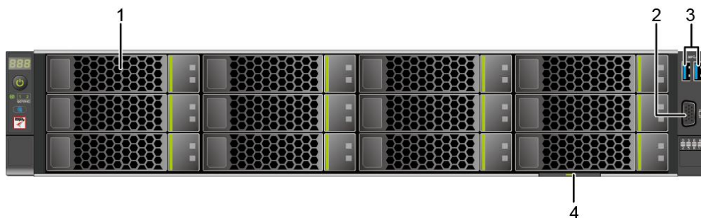
图 3-1 12x3.5 英寸硬盘配置前面板组件
