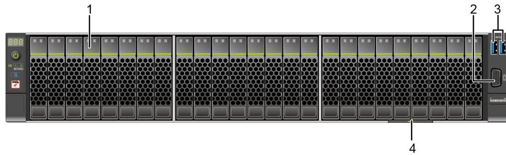
图4-2 25x2.5 英寸硬盘配置前面板组件
