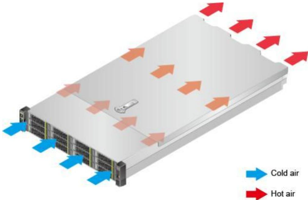
图5-4 36x3.5 英寸硬盘机箱散热气流走向示意图
