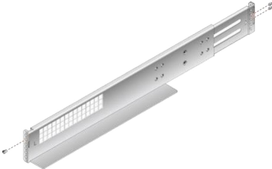
2. 如图5-12中①所示，将滑道水平放入规划的位置，根据机柜的长度将滑道向两侧导槽拉伸，使滑道的固定孔与机柜内侧导槽的安装孔对齐，滑道上前后限位销钉穿出方孔，预定位置滑道。
