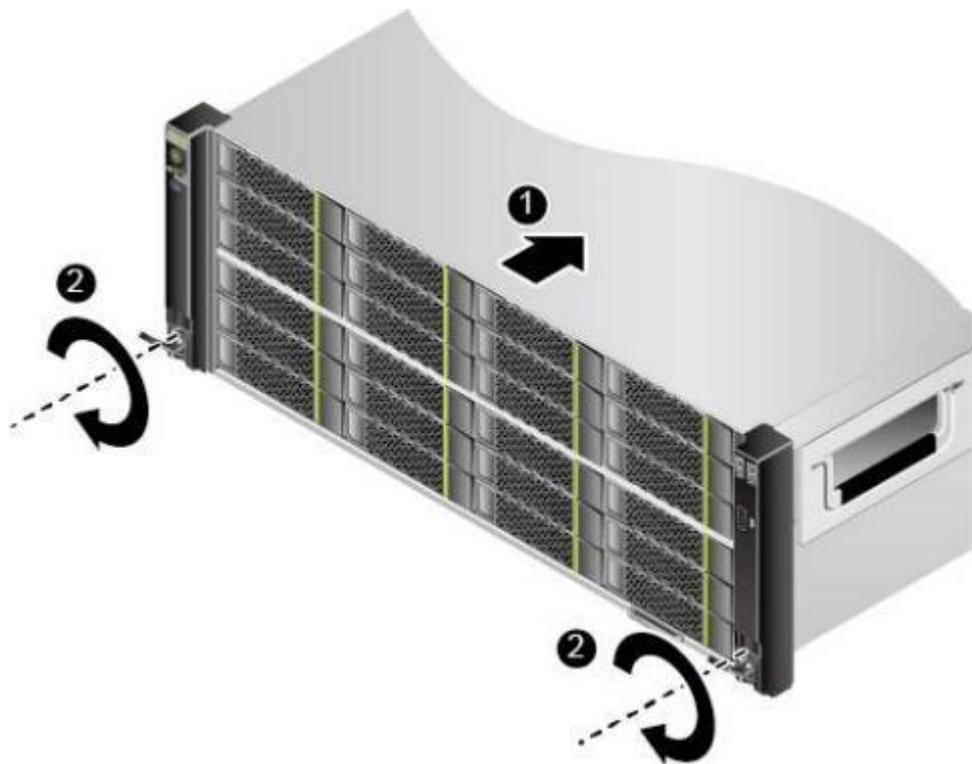
3. 如图5-13中②所示，将服务器两侧挂耳紧贴方孔条，按顺时针方向拧紧挂耳上的松不脱螺钉，固定服务器。
