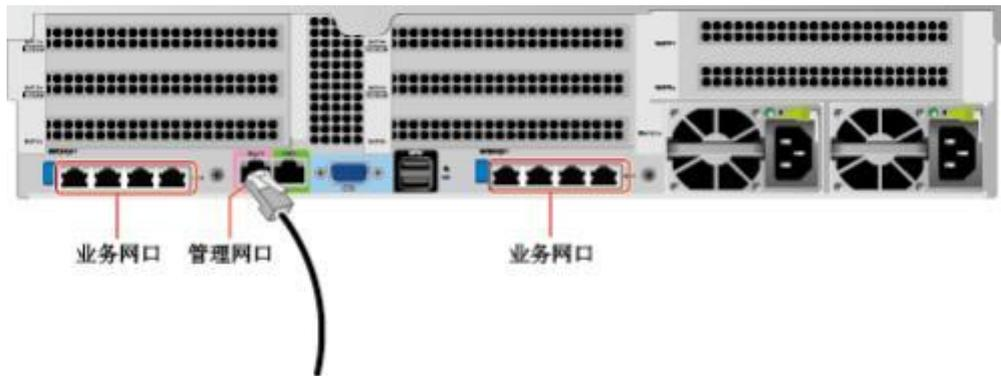
图5-18 36x3.5 英寸硬盘机箱连接网线
