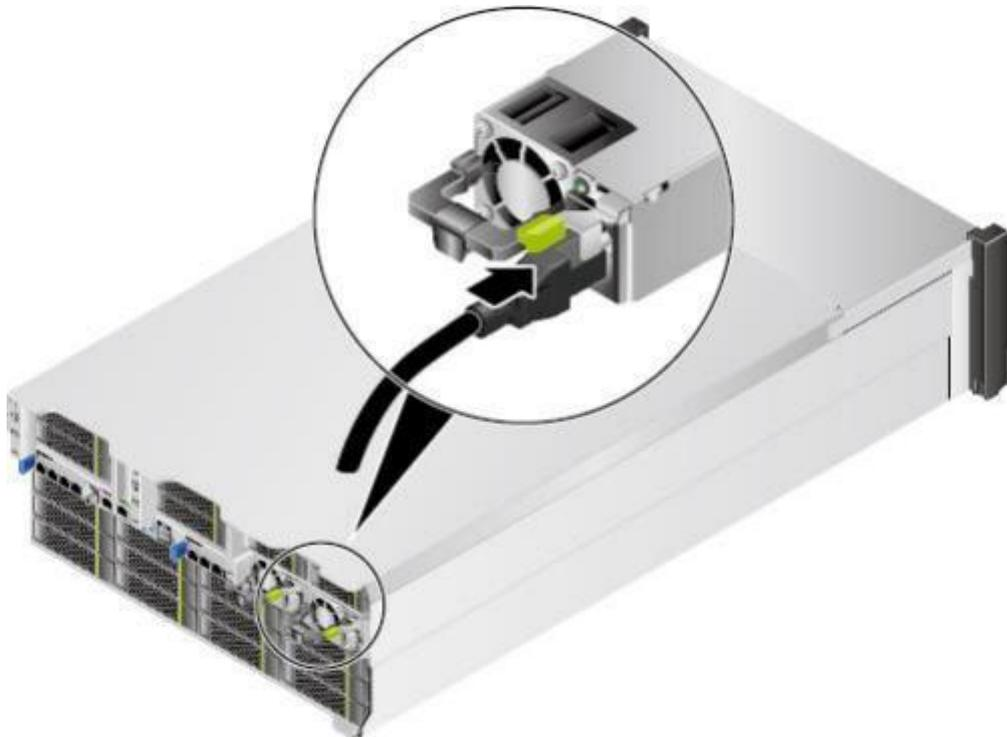
步骤 3 用魔术贴固定好电源线缆，如图5-28 所示。
