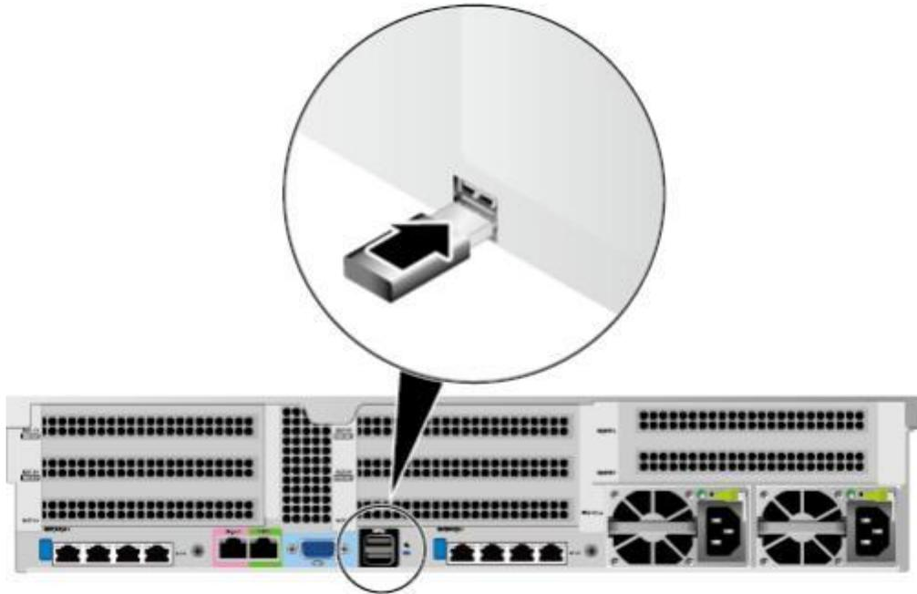
图5-23 36x3.5 英寸硬盘机箱连接 USB 接口
