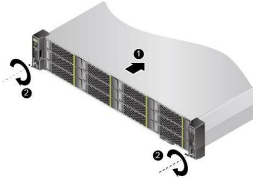
图5-14 36x3.5 英寸硬盘机箱安装服务器
