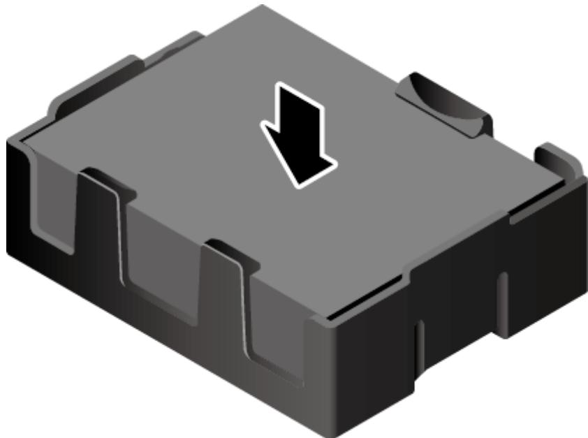
步骤 8 将超级电容支架固定到导风罩上，如图 5-122 所示。
