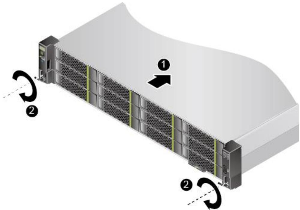
图5-12 36x3.5 英寸硬盘机箱安装服务器
