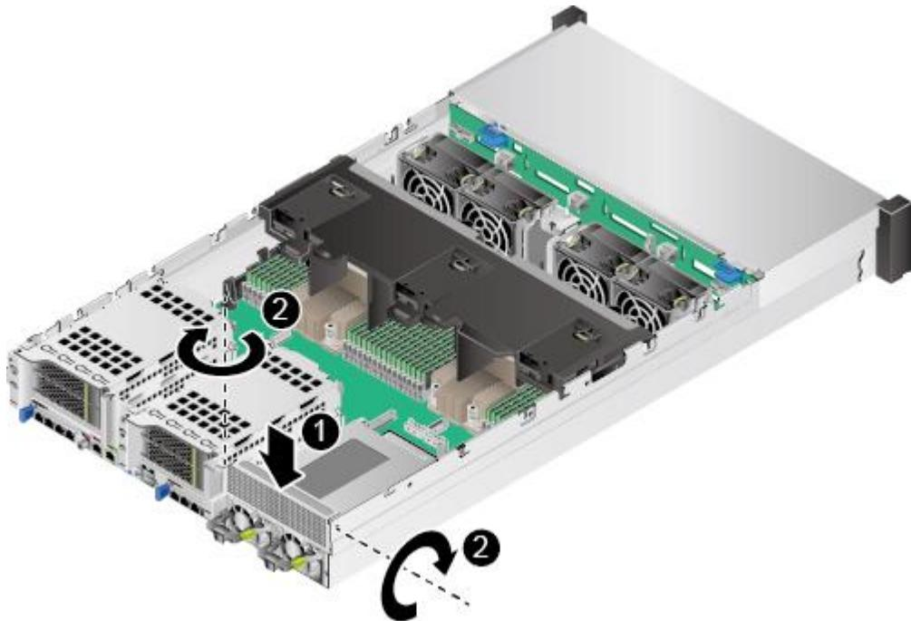
图5-84 36x3.5 英寸硬盘机箱安装空闲挡板 (3)
