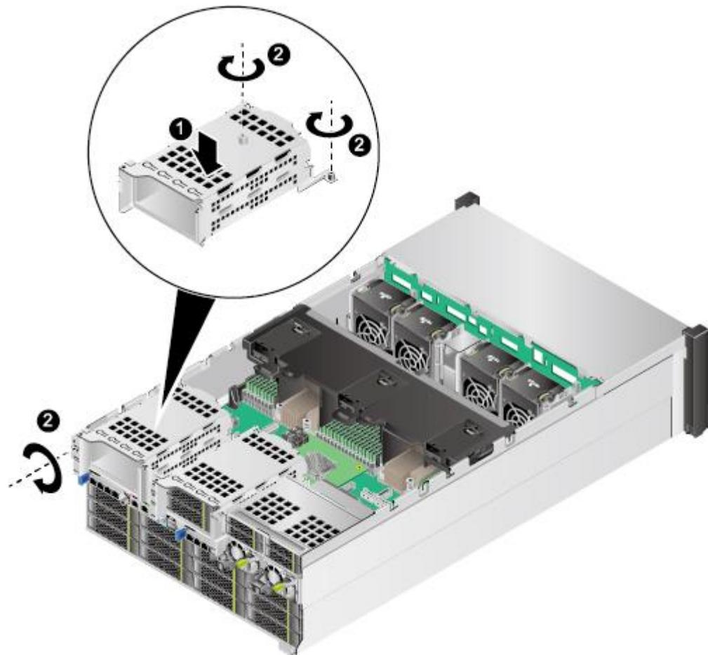
步骤 8 确认后置硬盘模组中硬盘的位置，如图 5-150 所示。安装后置硬盘模组中的所有硬盘。
