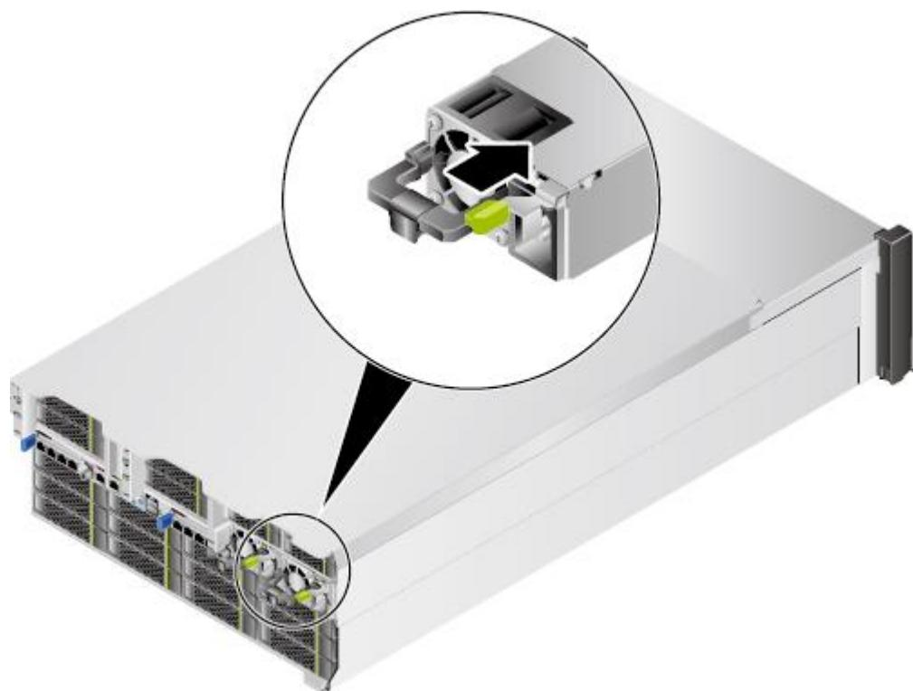
步骤 5 将电源线缆的一端插入服务器交流电源模块的线缆接口，如图 5-41 所示。
