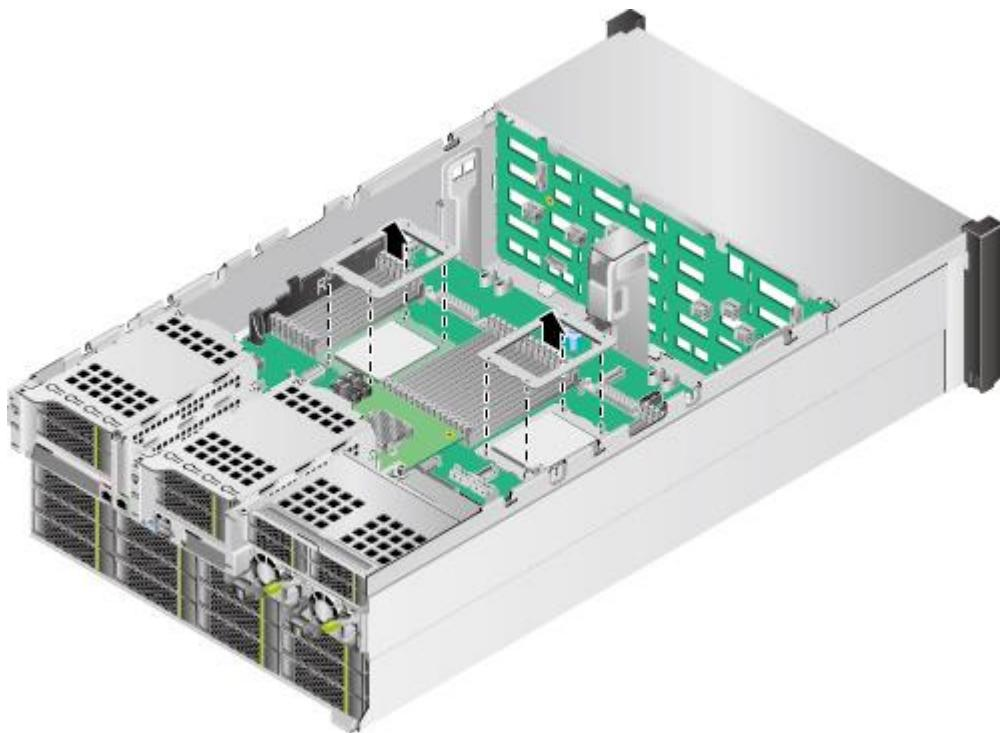
步骤 17 拆卸 RAID 控制扣卡。具体操作方法请参见 5.15 RAID 控制扣卡。
