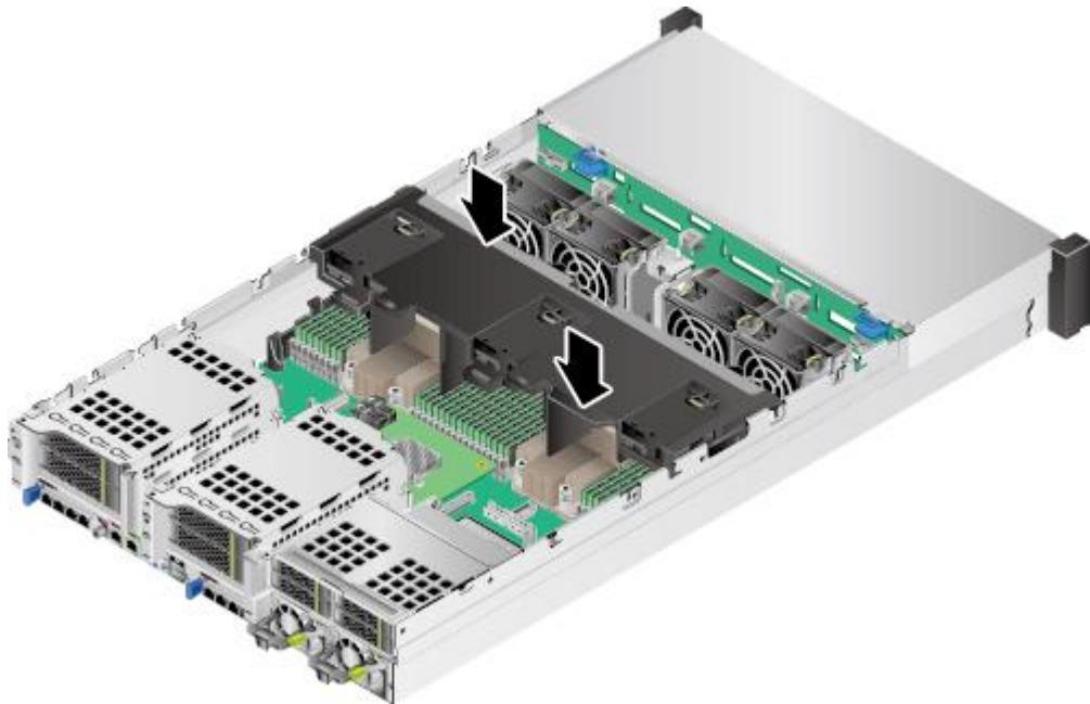
图5-64 36x3.5 英寸硬盘机箱安装导风罩
