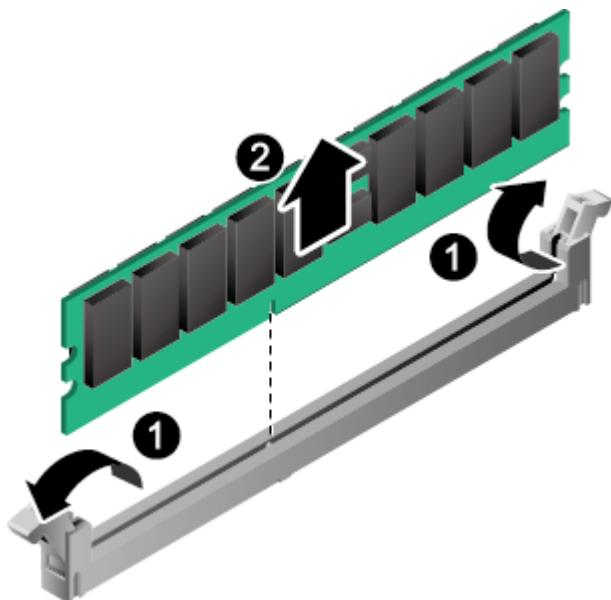
步骤 8 将 DIMM 从插槽中取出，如图 5-125 中②所示。
