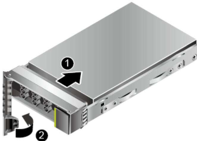
步骤 6 待硬盘扳手已经扣住机箱横梁，闭合硬盘扳手，利用扳手和机箱之间的切合力将硬盘完全推入机箱，如图 5-28 中②所示。
