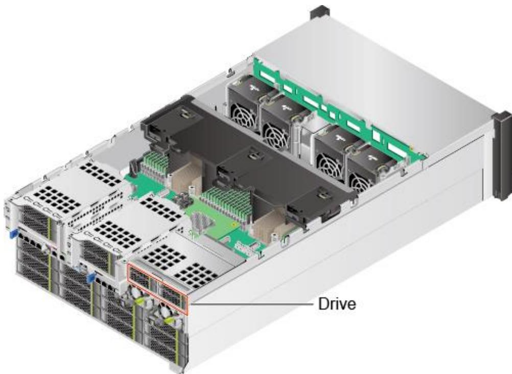
步骤 8 拧开固定后置硬盘组件的螺钉，如图 5-154 中①所示。
