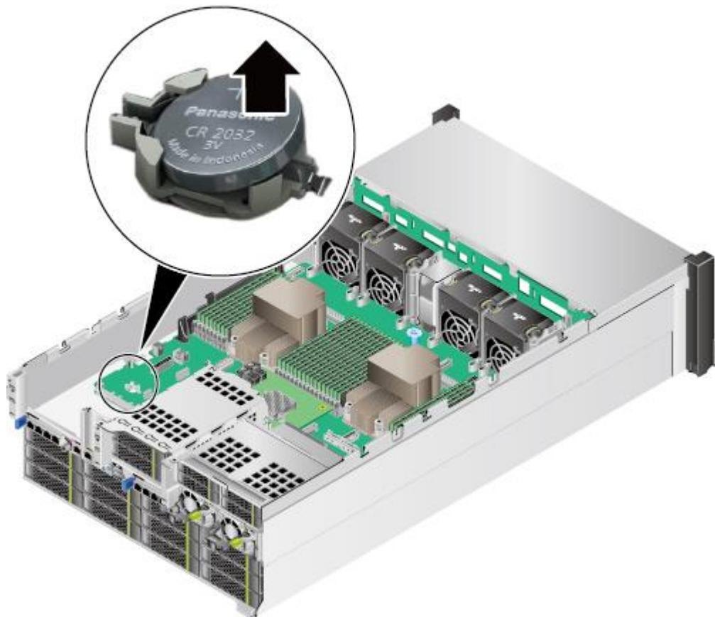
步骤 8 将拆卸的电池放入防静电包装袋内。
