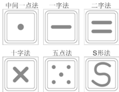
导热硅脂的厚度大约为一张普通纸的厚度。最终涂抹效果如图 5-196 所示，要保证导热硅脂涂抹均匀并且涂满。
