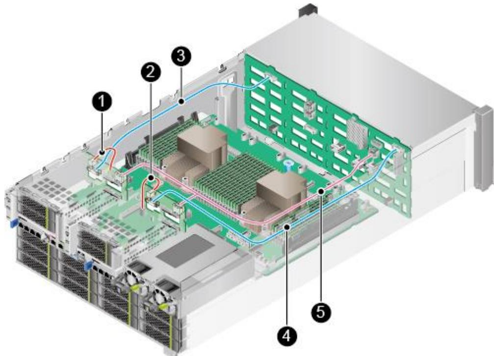
表3-17 IO 模组 1 和 IO 模组 2 硬盘背板连线
