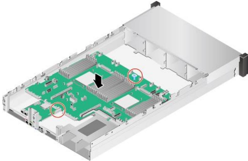
图5-190 36x3.5 英寸硬盘机箱安装主板
