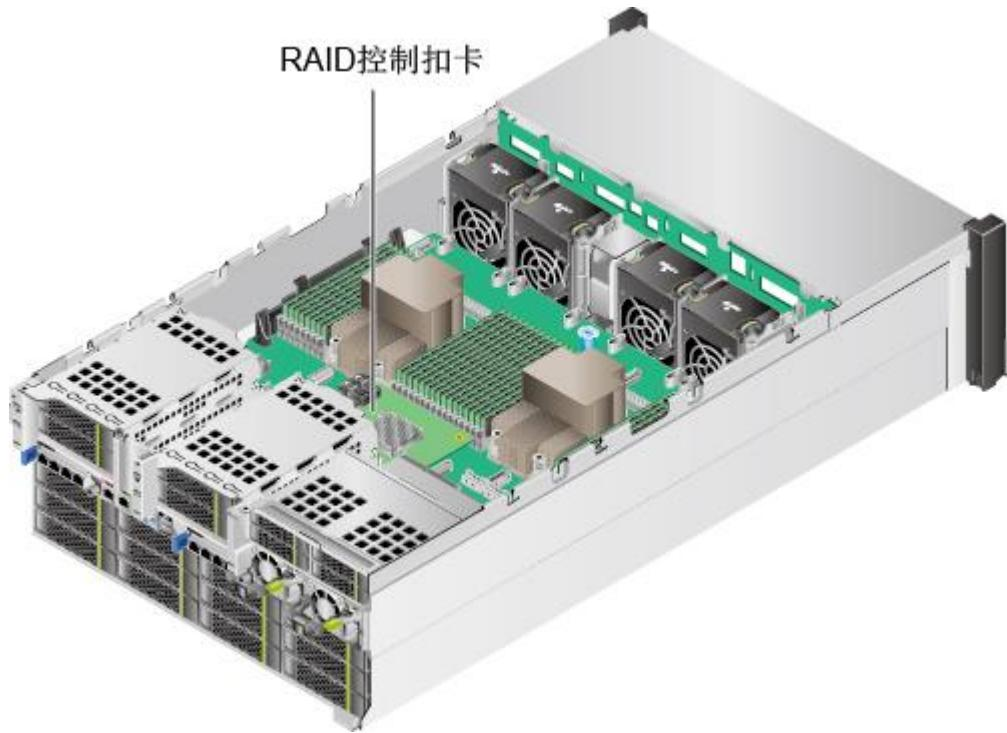
步骤 10 对准 RAID 控制扣卡和主板相对应的接口，向下缓慢用力插入 RAID 控制扣卡，如图 5-116 中①所示。
