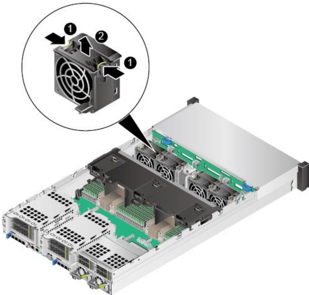
图5-68 36x3.5 英寸硬盘机箱拆卸风扇模块
