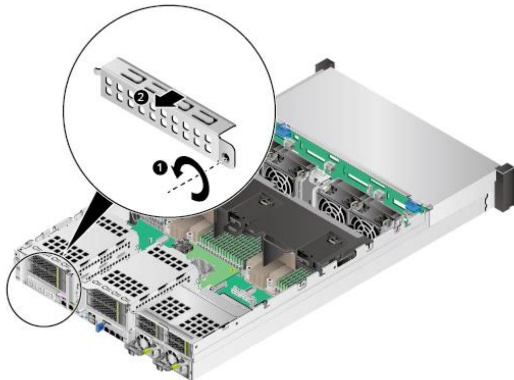
图5-133 36x3.5 英寸硬盘机箱拆卸灵活 IO 卡空闲挡板
