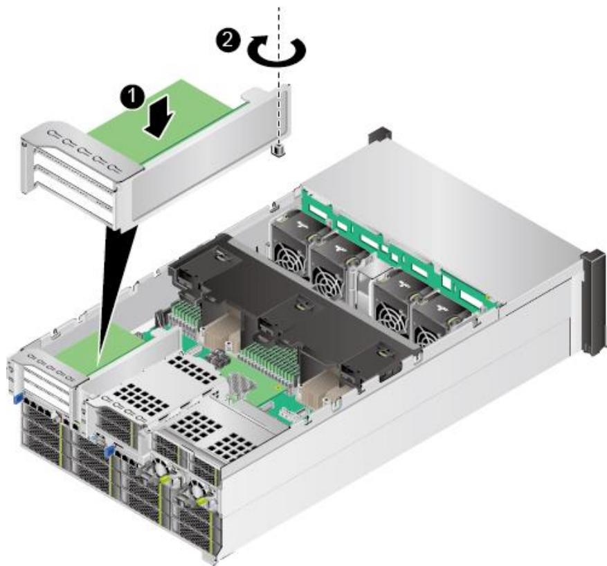
图5-93 25x2.5 英寸或 12x3.5 英寸硬盘机箱安装 Riser 模组 2
