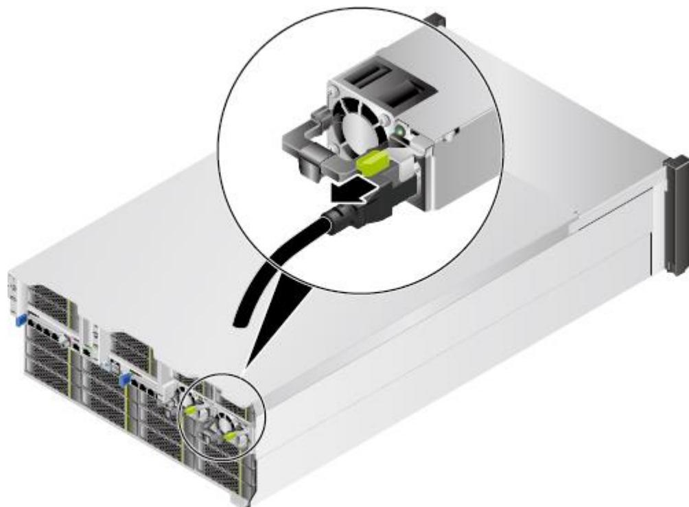
步骤 6 沿箭头方向按住电源模块弹片，同时用力拉住扳手，向外拔出电源模块，如图 5-33 所示。
