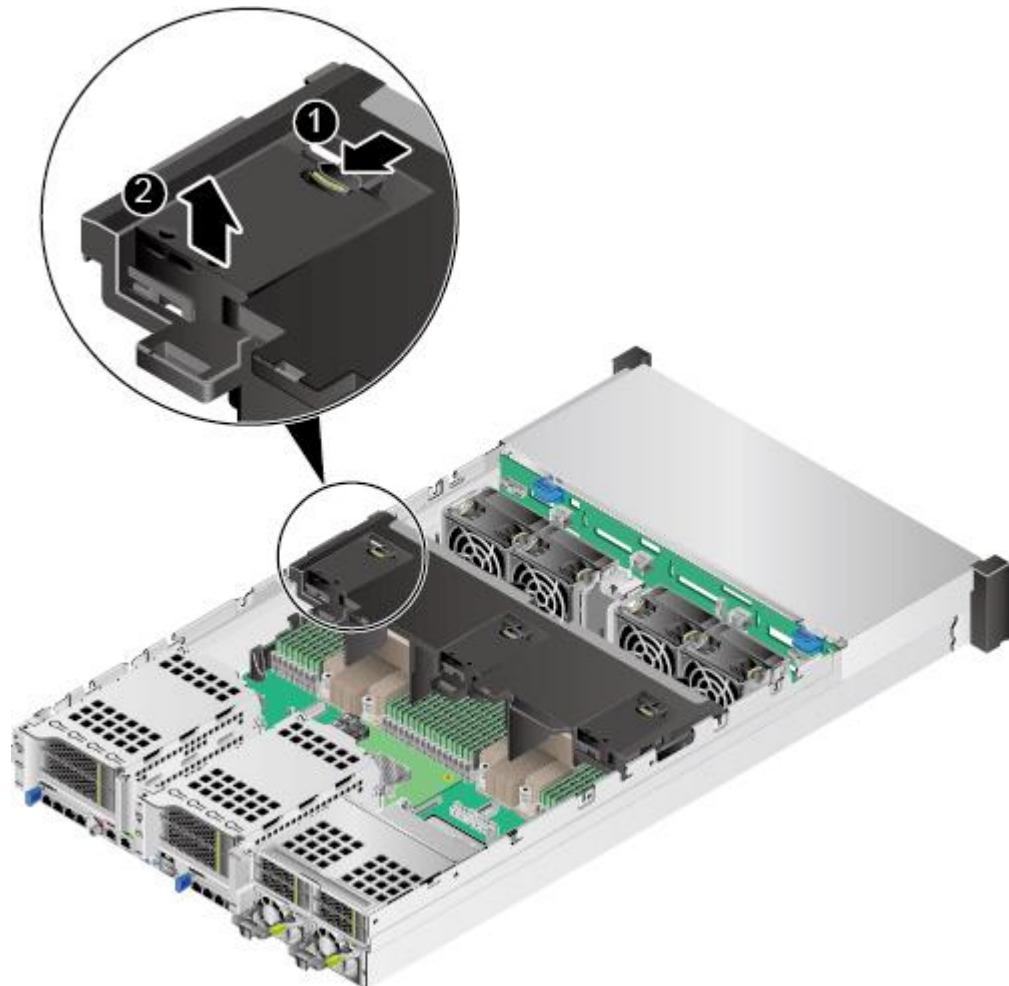
图5-119 36x3.5 英寸硬盘机箱拆卸超级电容支架
