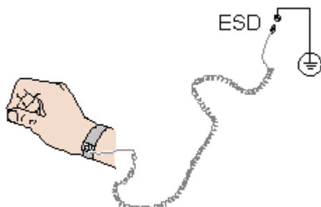
步骤 2 拉紧锁扣，确认防静电腕带与皮肤接触良好。
