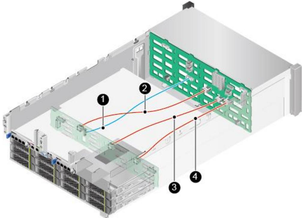
表3-15 后置 12 盘硬盘背板的 SAS 信号线和低速信号线
