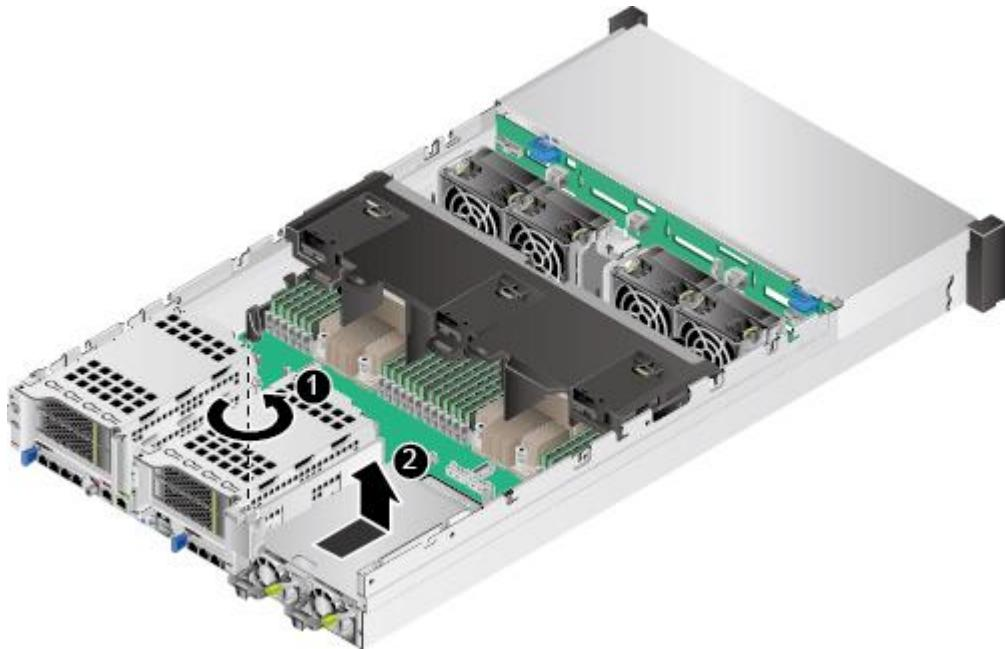
图5-78 36x3.5 英寸硬盘机箱拆卸 Riser 模组 3 的下托架
