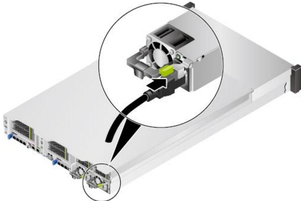
图5-42 36x3.5 英寸硬盘机箱连接电源线缆
