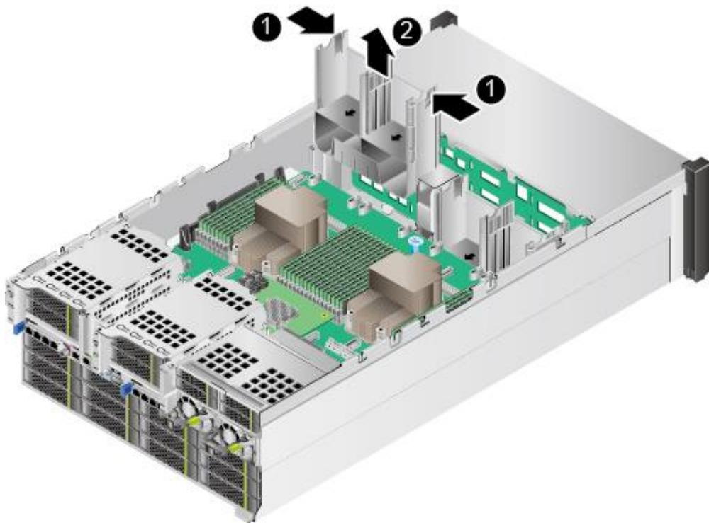
步骤 10 拆除连接到硬盘背板的所有线缆。详细信息请参见 3 内部布线。
