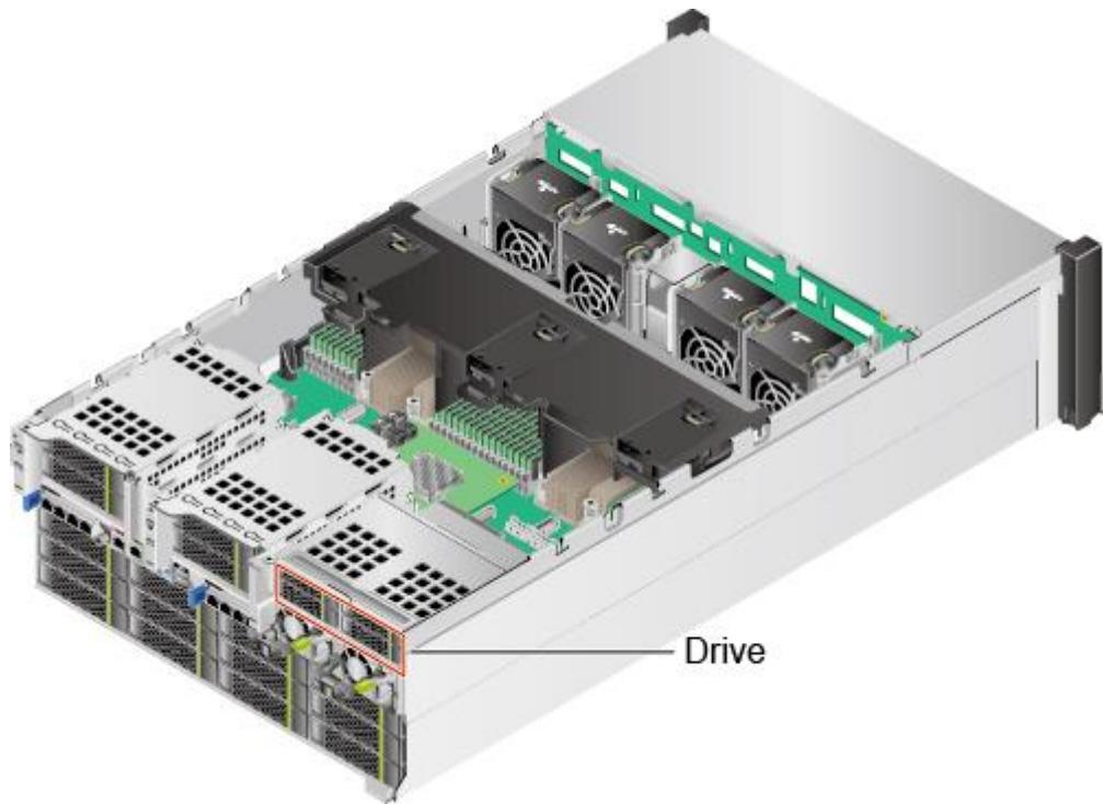
步骤 9 连接后置硬盘模组的线缆。具体操作方法请参见 3 内部布线。
