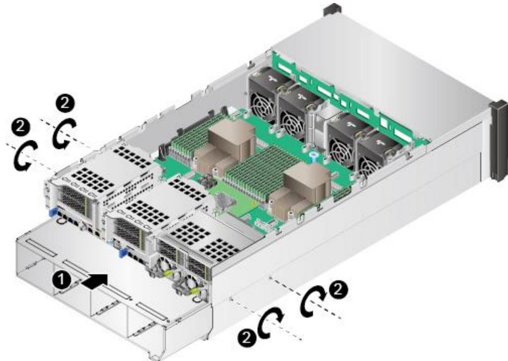
步骤 6 确认后置硬盘组件中硬盘的位置，如图 5-167 所示。安装硬盘组件中的所有硬盘。
