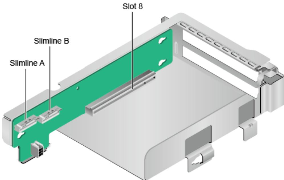
PCIe 插槽分布后视图如图 2-37 所示。
