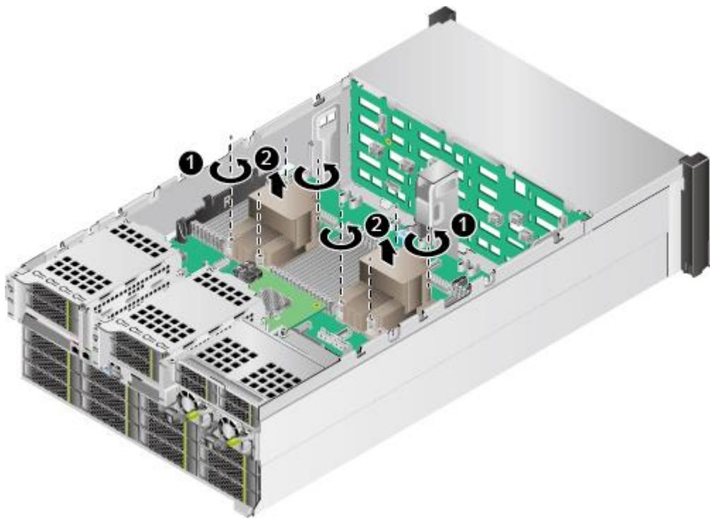
步骤 16 向上取出 CPU 托架。
