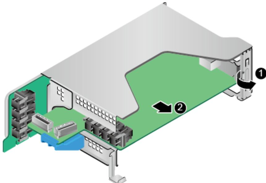
步骤 9 拔出 IOB 卡，如图 5-103 中②所示。
