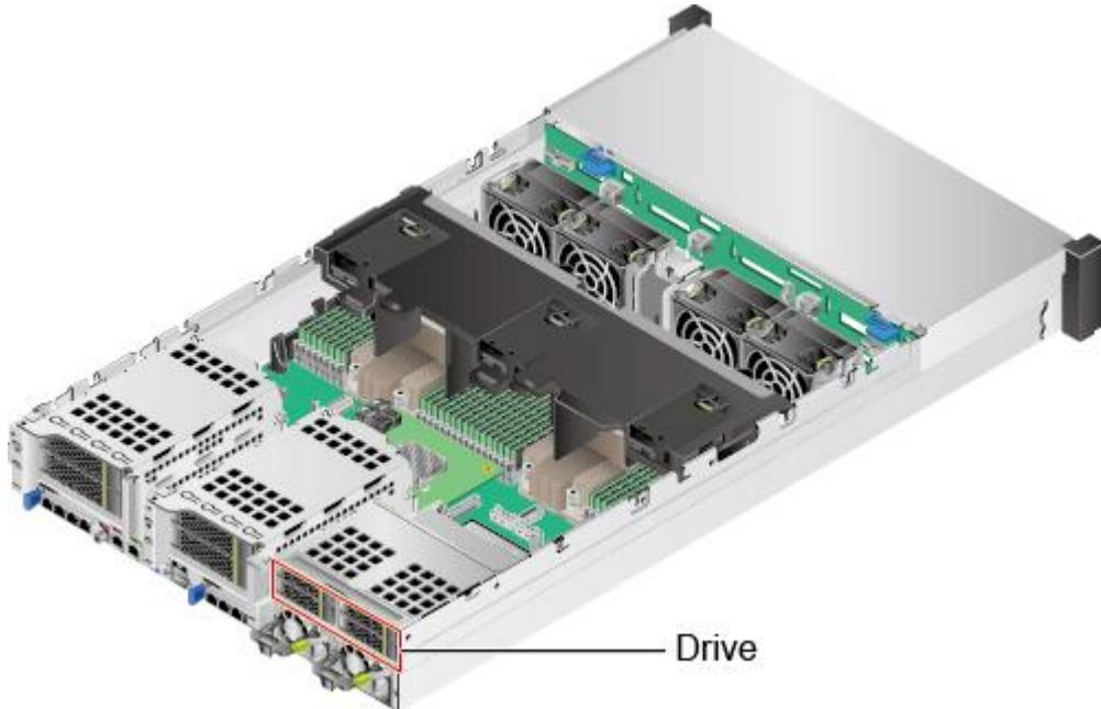
图5-153 36x3.5 英寸硬盘机箱硬盘位置
