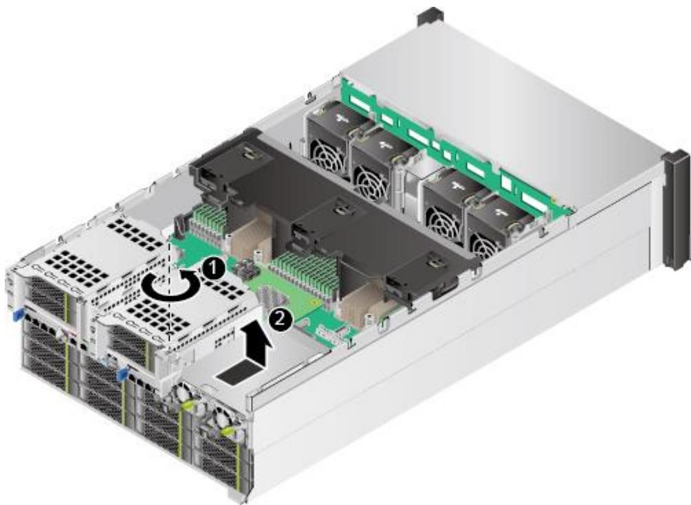
步骤 8 拆卸 Riser 模组中的 PCIe 卡。具体方法请参见 5.12 Riser 模组上的 PCIe 卡。
