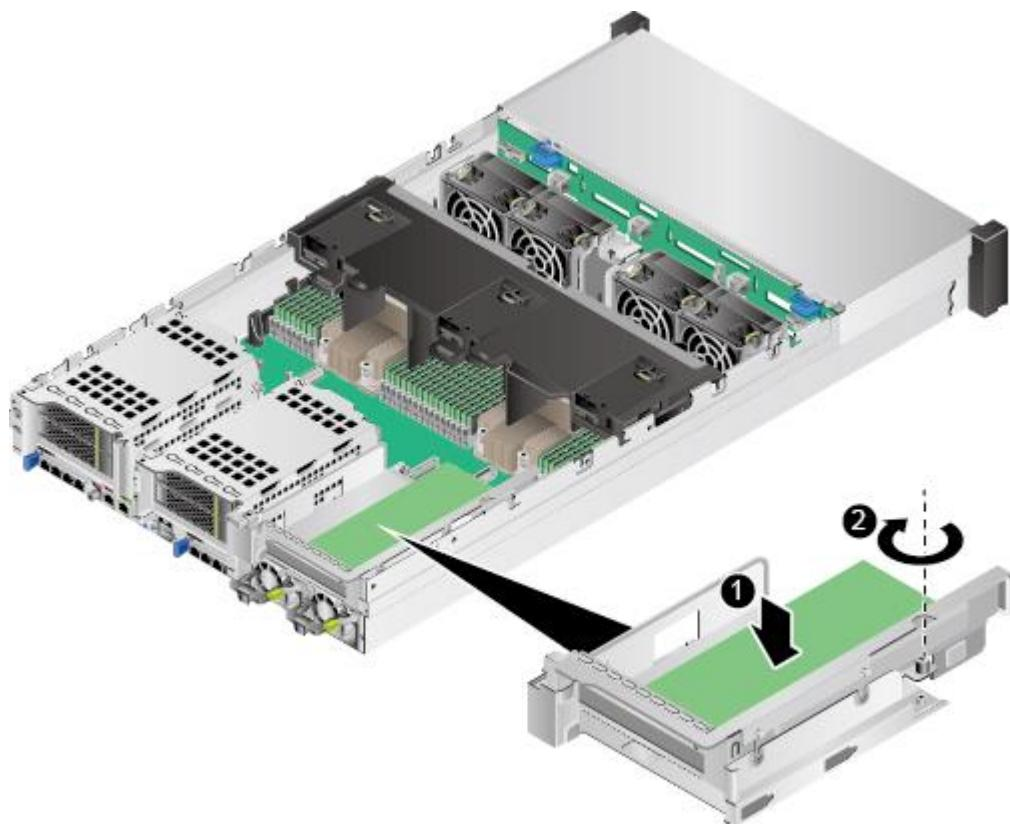
图5-98 36x3.5 英寸硬盘机箱安装 Riser 模组 3 的上托架
