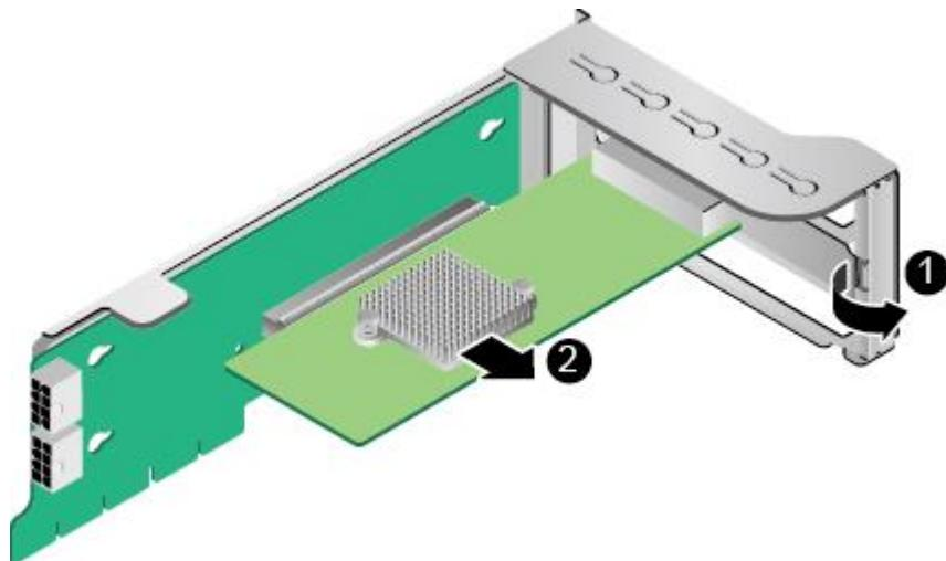
步骤 8 拔出 PCIe 卡，如图 5-99 中②所示。
