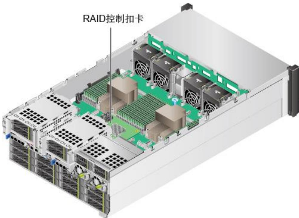
步骤 9 按住 RAID 控制扣卡线缆的卡扣并向外拔出线缆，详细信息请参见 3 内部布线。
