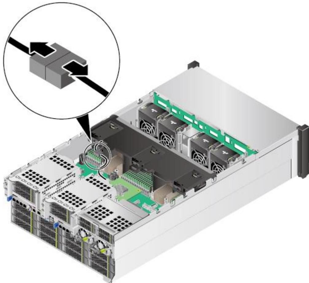
步骤 8 根据导风罩上的提示手位标识向上抬起导风罩，如图 5-61 所示。
