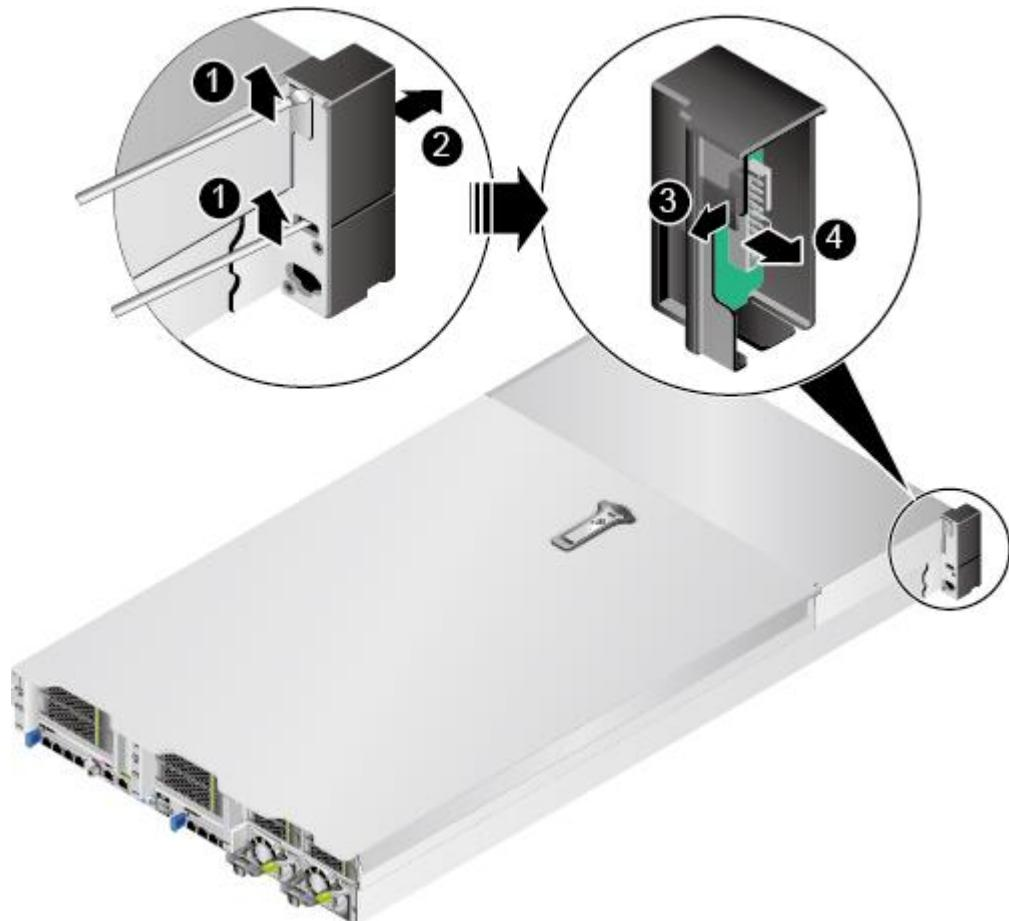
图5-170 36x3.5 英寸硬盘机箱拆卸左挂耳板
