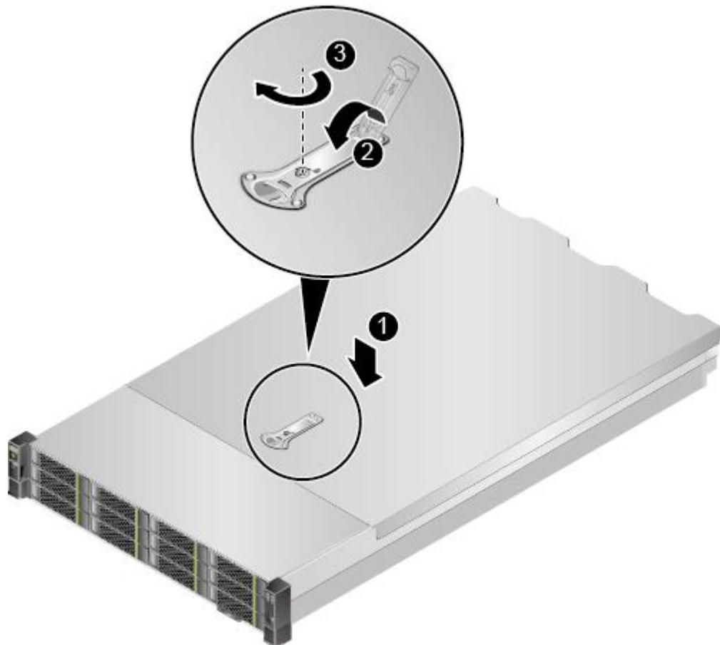
图5-58 36x3.5 英寸硬盘机箱安装机箱盖
