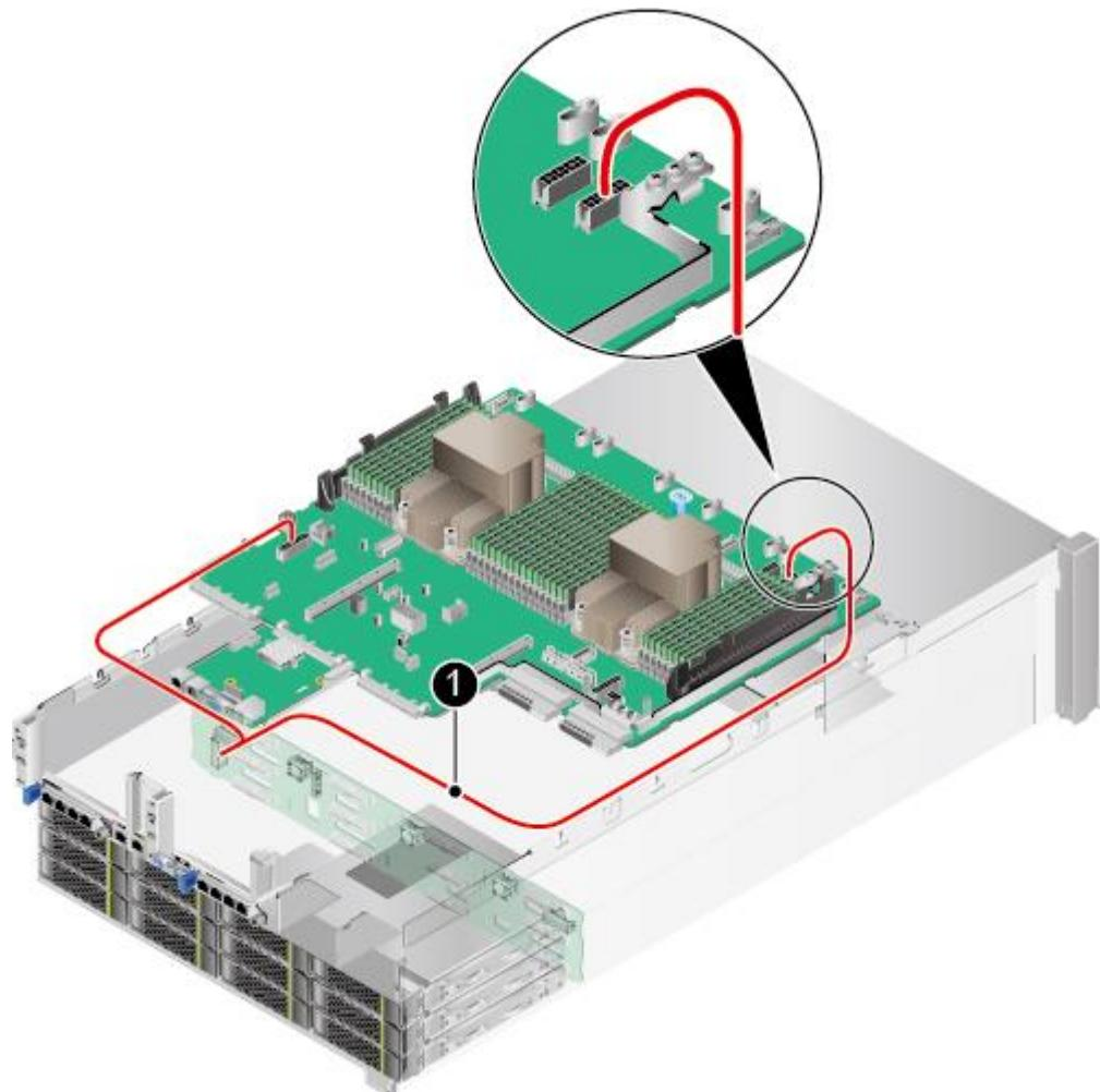
表3-16 后置 12 盘硬盘背板的电源线
