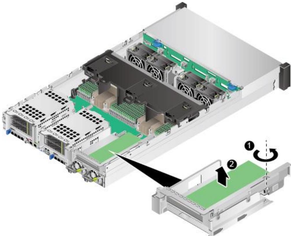
图5-76 36x3.5 英寸硬盘机箱拆卸 Riser 模组 3 的上托架
