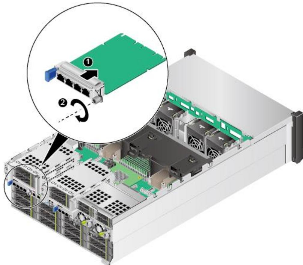
步骤 8 用十字螺丝刀拧紧灵活 IO 卡的固定螺钉，如图 5-134 中②所示。
