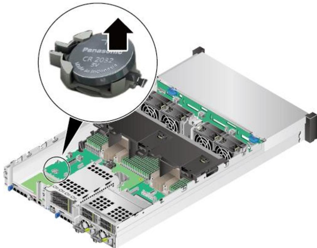
图5-108 36x3.5 英寸硬盘机箱拆卸电池
