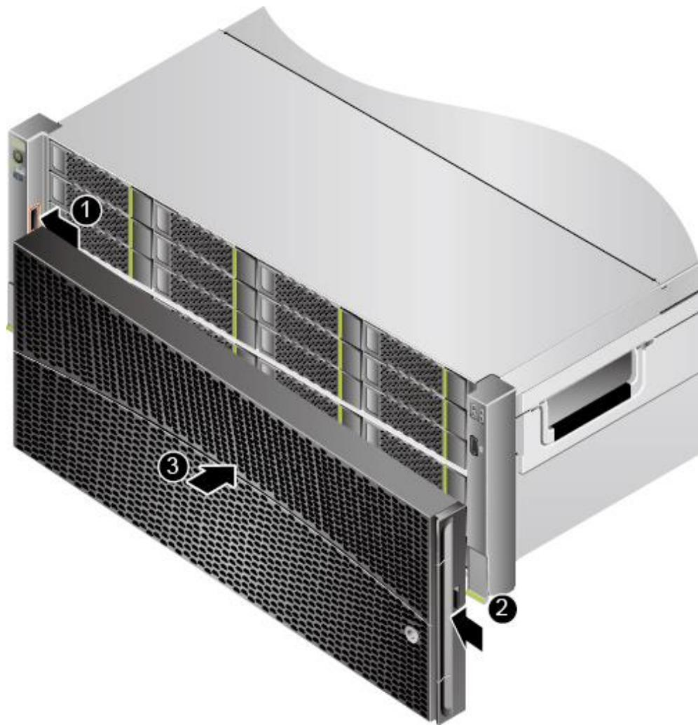
步骤3 插入钥匙，逆时针旋转锁上安全面板，拔出钥匙，如图 5-25 中①、②所示。
