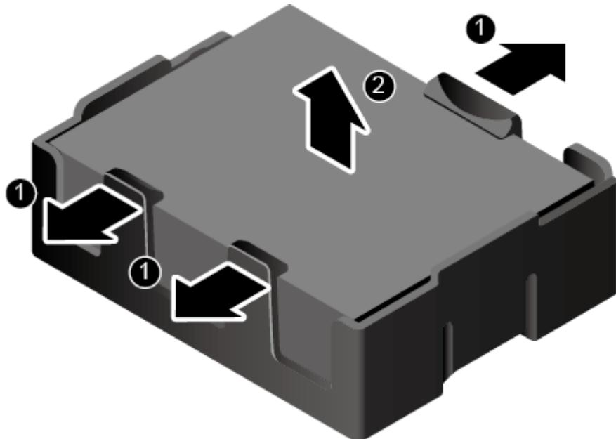
步骤 9 向上均匀用力将超级电容拔离托架，如图 5-120 中②所示。
