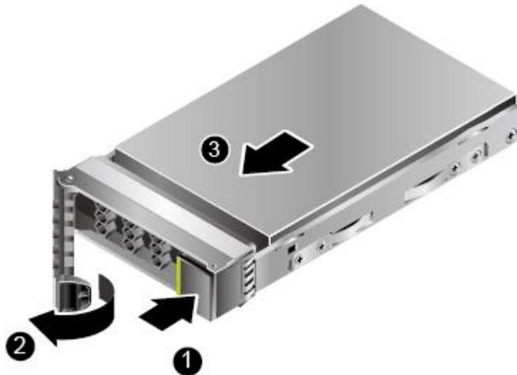
步骤 4 拉住硬盘托架扳手，将硬盘向外拔出约 3cm，硬盘脱机，如图 5-27 中②所示。对于 SAS/SATA 硬盘，硬盘脱机后，等待至少 30 秒，硬盘完全停止转动后再将硬盘拔出服务器；对于 NVMe 硬盘，硬盘脱机后，直接将硬盘拔出服务器，如图 5-27 中③所示。
