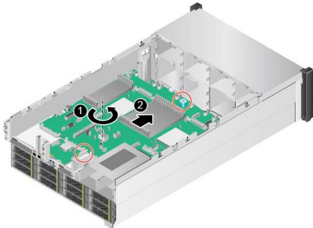
步骤 22 通过红圈内标出的提手将主板往风扇方向推到不动为止，如图 5-185 中②所示。
