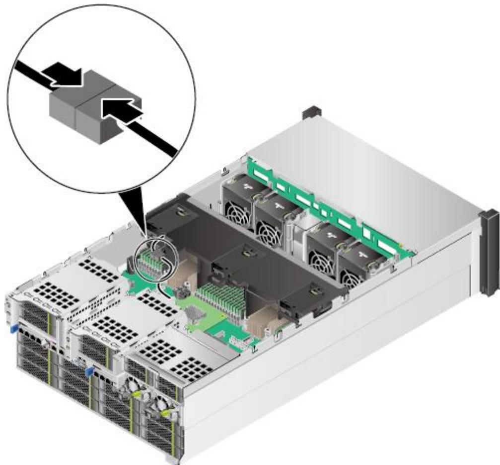
步骤 10 (可选) 如果 IO 模组 1 或 IO 模组 2 选配全高全长 Riser 模组, 需要安装全高全长 Riser 模组。
