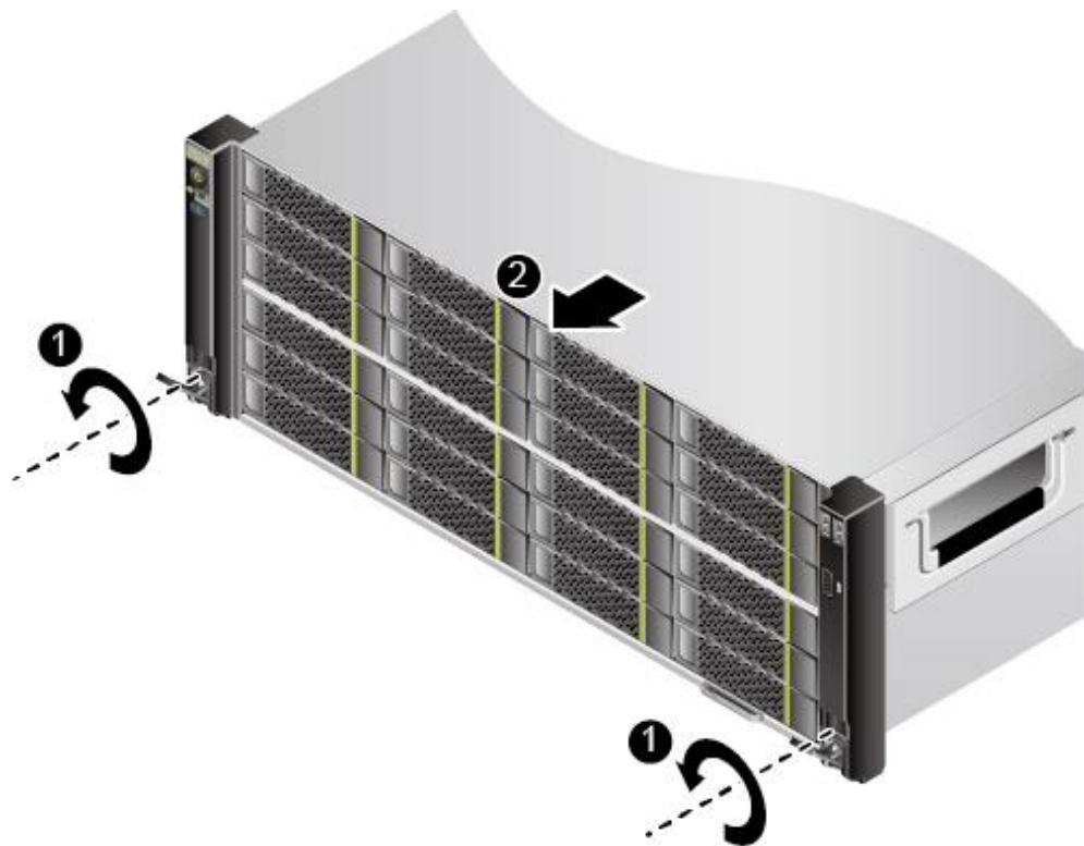
2. 如图 5-13 中②所示，沿滑轨向远离机柜的方向缓慢拉出服务器。
