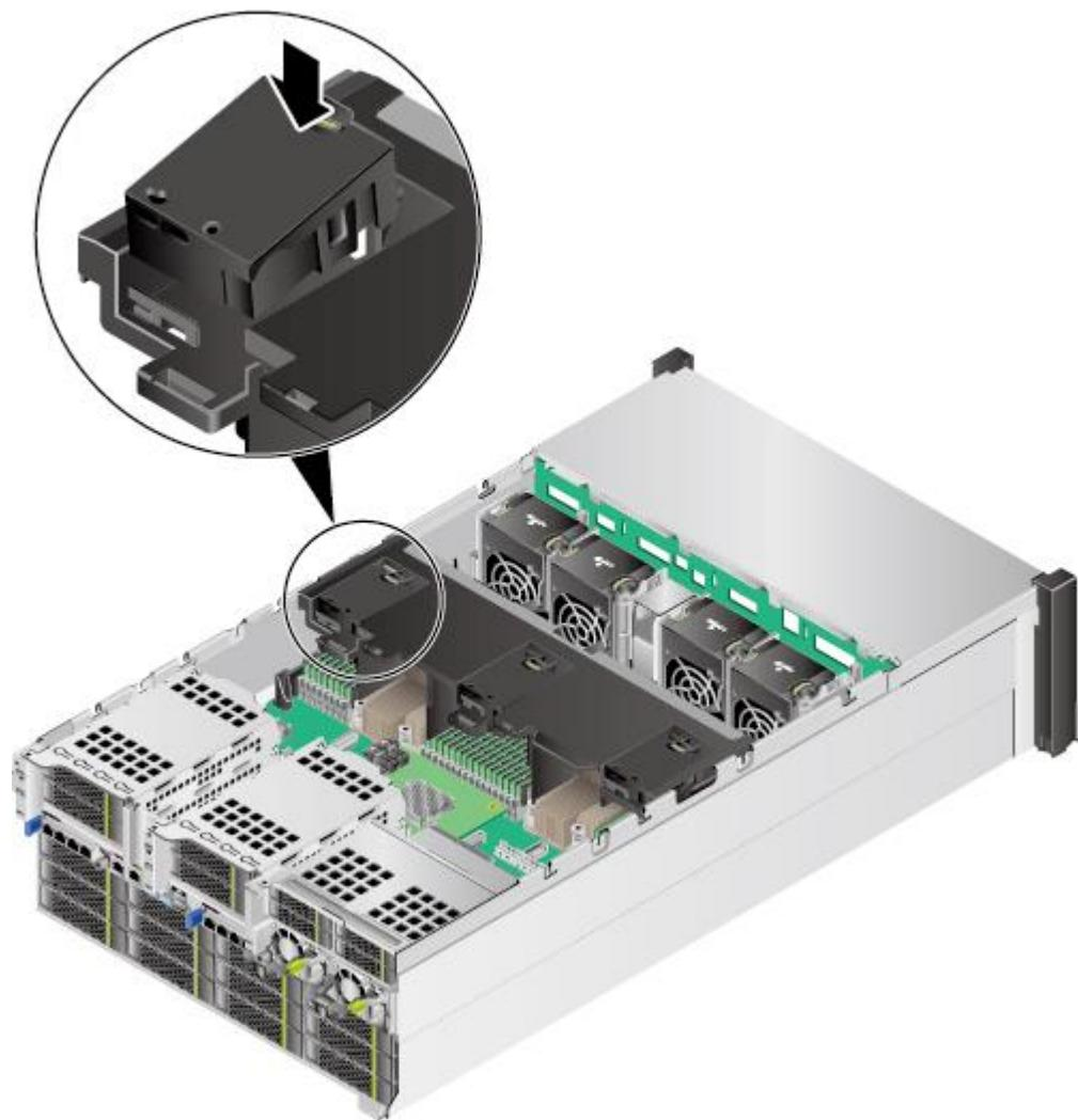
步骤 9 将超级电容线缆插入 RAID 卡超级电容线缆接口，如图 5-124 所示。
