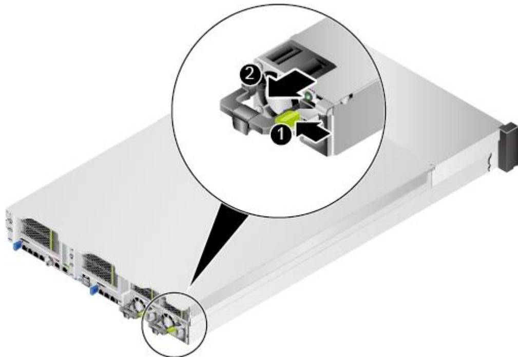
图5-34 36x3.5 英寸硬盘机箱拆卸电源模块
