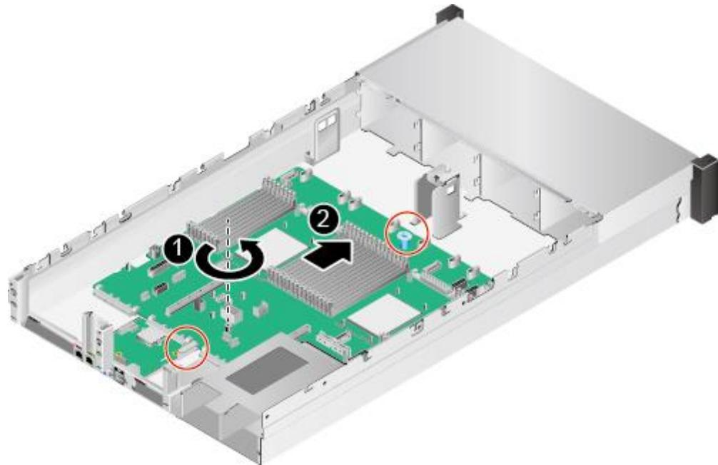
图5-186 36x3.5 英寸硬盘机箱拆卸主板
