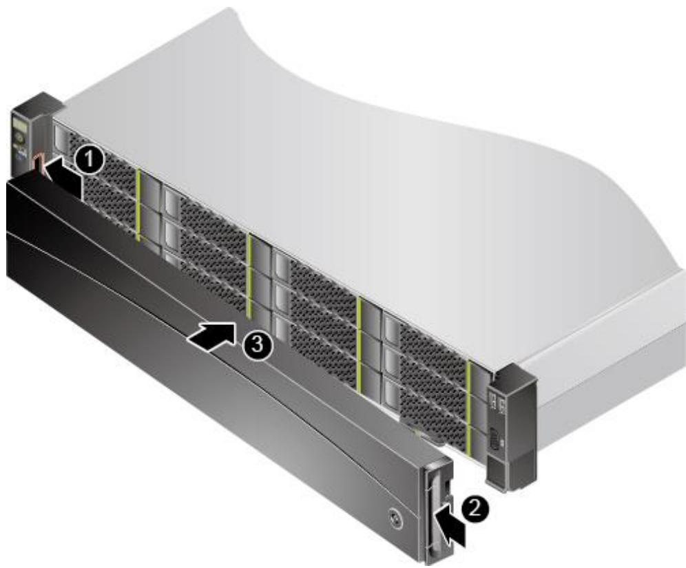
图5-24 36x3.5 英寸硬盘机箱安装安全面板
