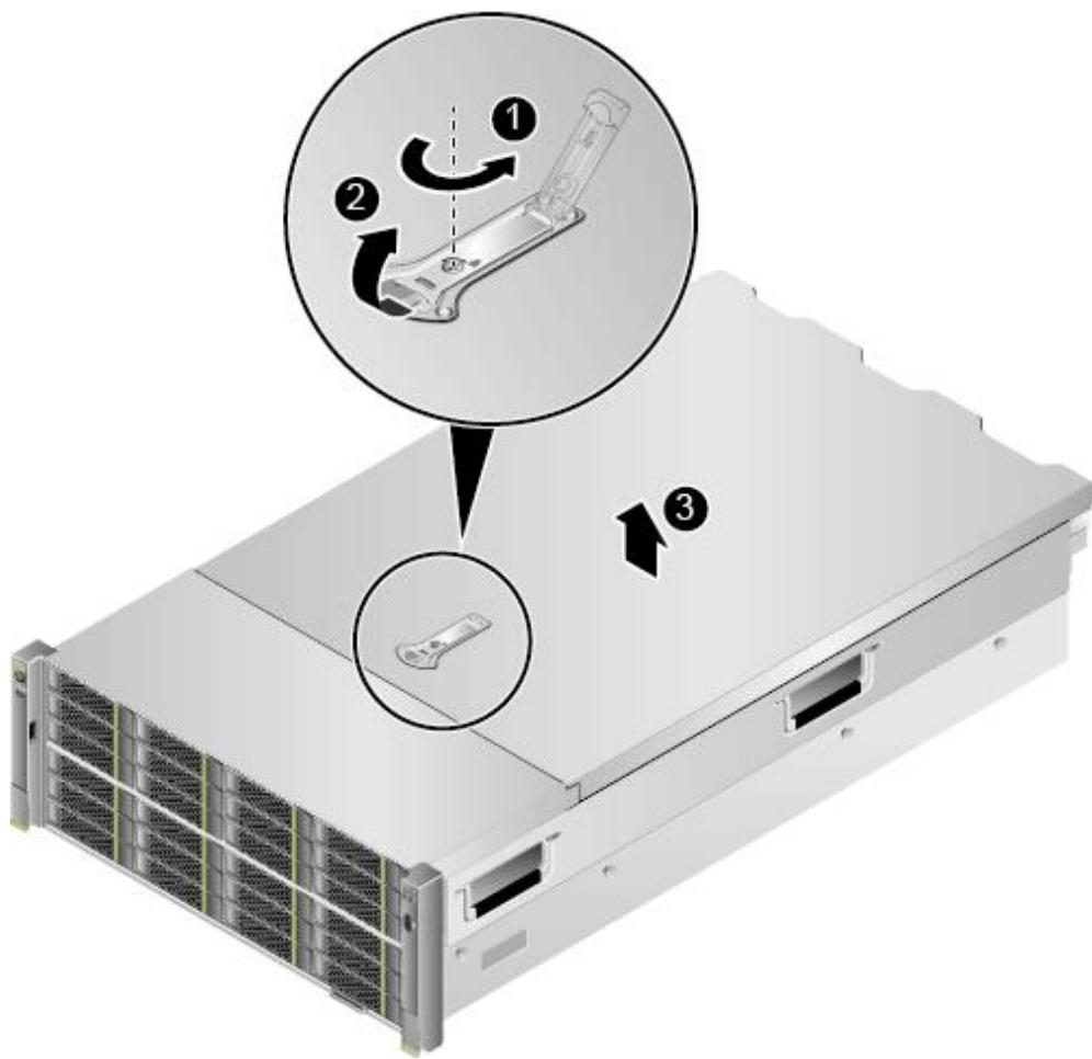
步骤 6 打开机箱盖扳手，向后推开机箱盖，如图 5-55 中②所示。
