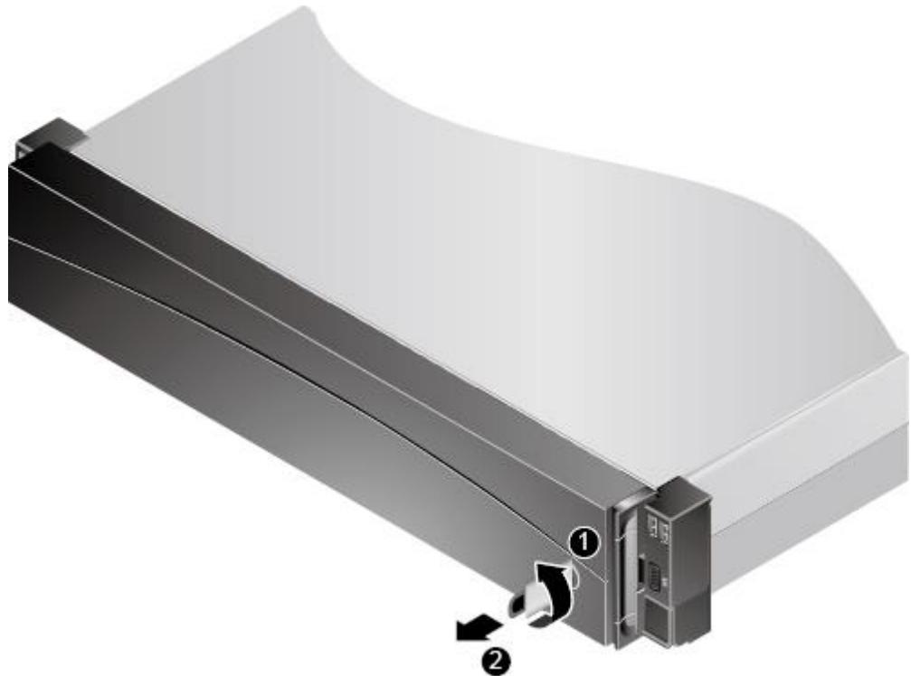
图5-26 36x3.5 英寸硬盘机箱锁定安全面板
