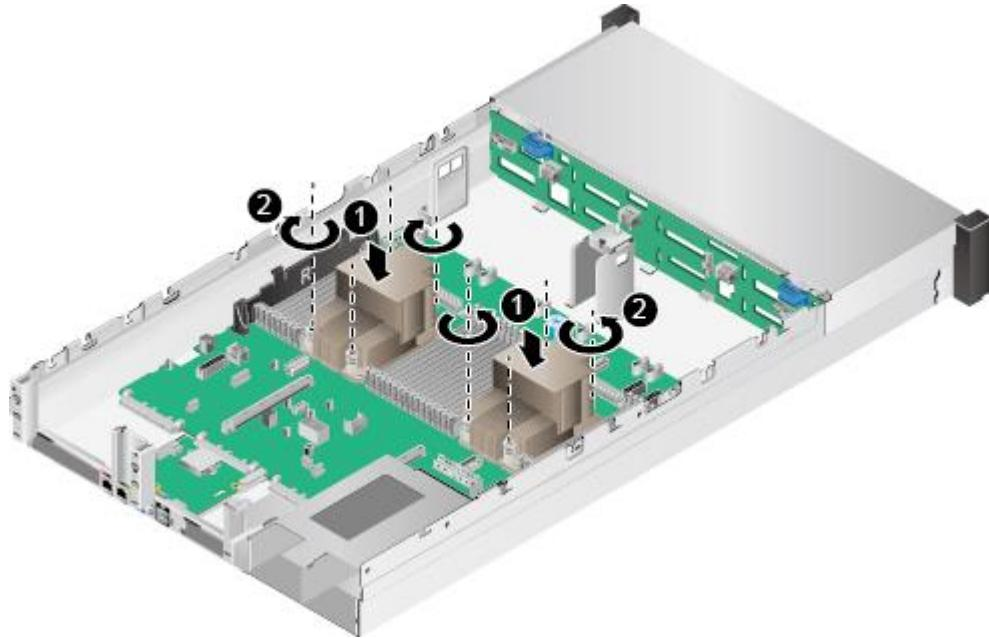
图5-200 36x3.5 英寸硬盘机箱安装 CPU 散热器
