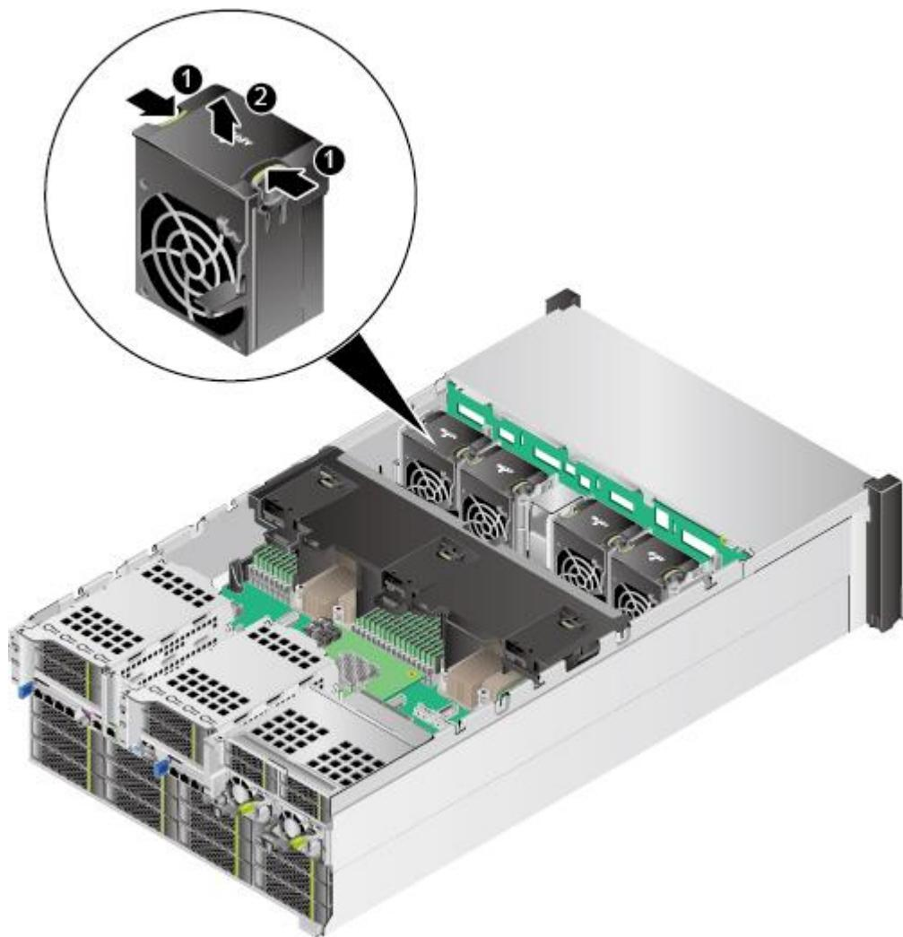
步骤 7 向上缓缓用力提起风扇模块，待风扇模块松动后，向上完全拆除风扇模块，如图 5-67 中②所示。
