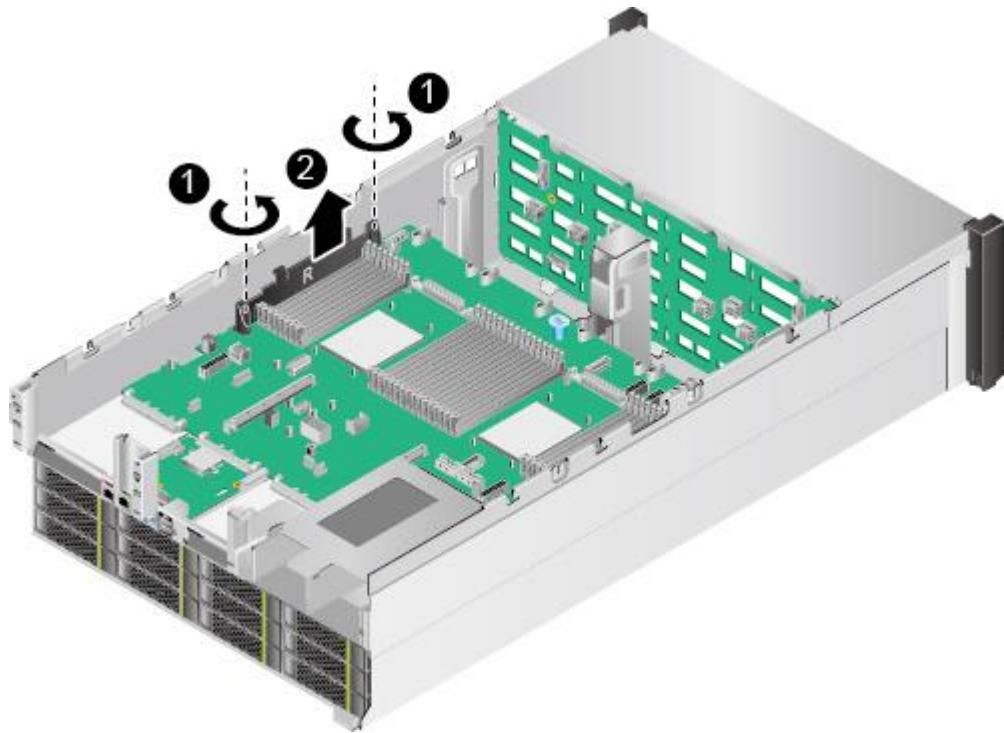
步骤 21 使用十字螺丝刀拧开主板松不脱螺钉，如图 5-185 中①所示。
