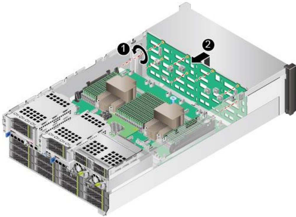
步骤 12 将拆卸的硬盘背板放入防静电包装袋内。
