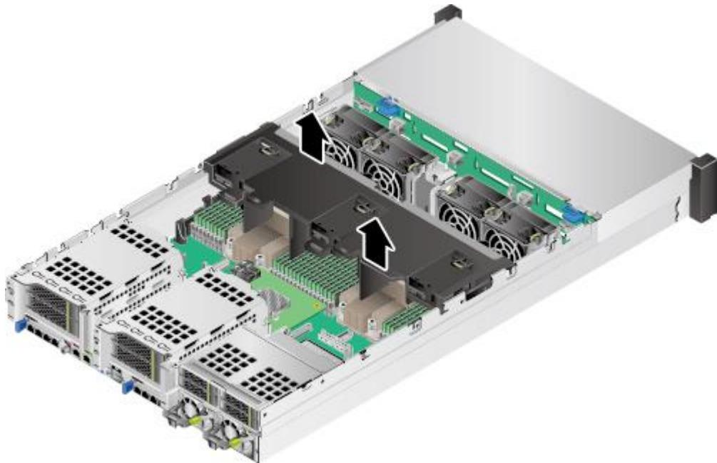
图5-62 36x3.5 英寸硬盘机箱拆卸导风罩
