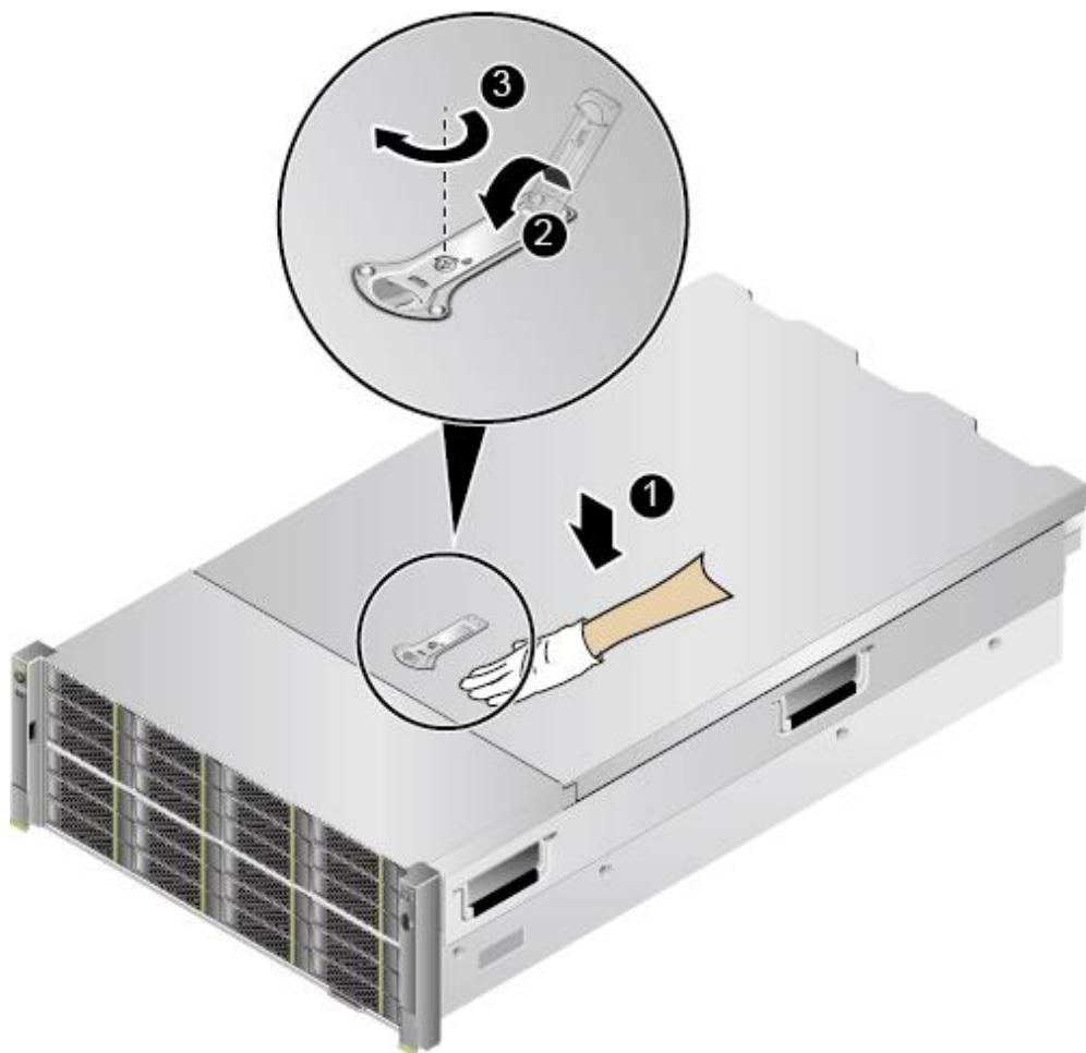
步骤3 用十字螺丝刀顺时针旋转扳手锁扣，固定机箱盖扳手，如图5-57中③所示。
