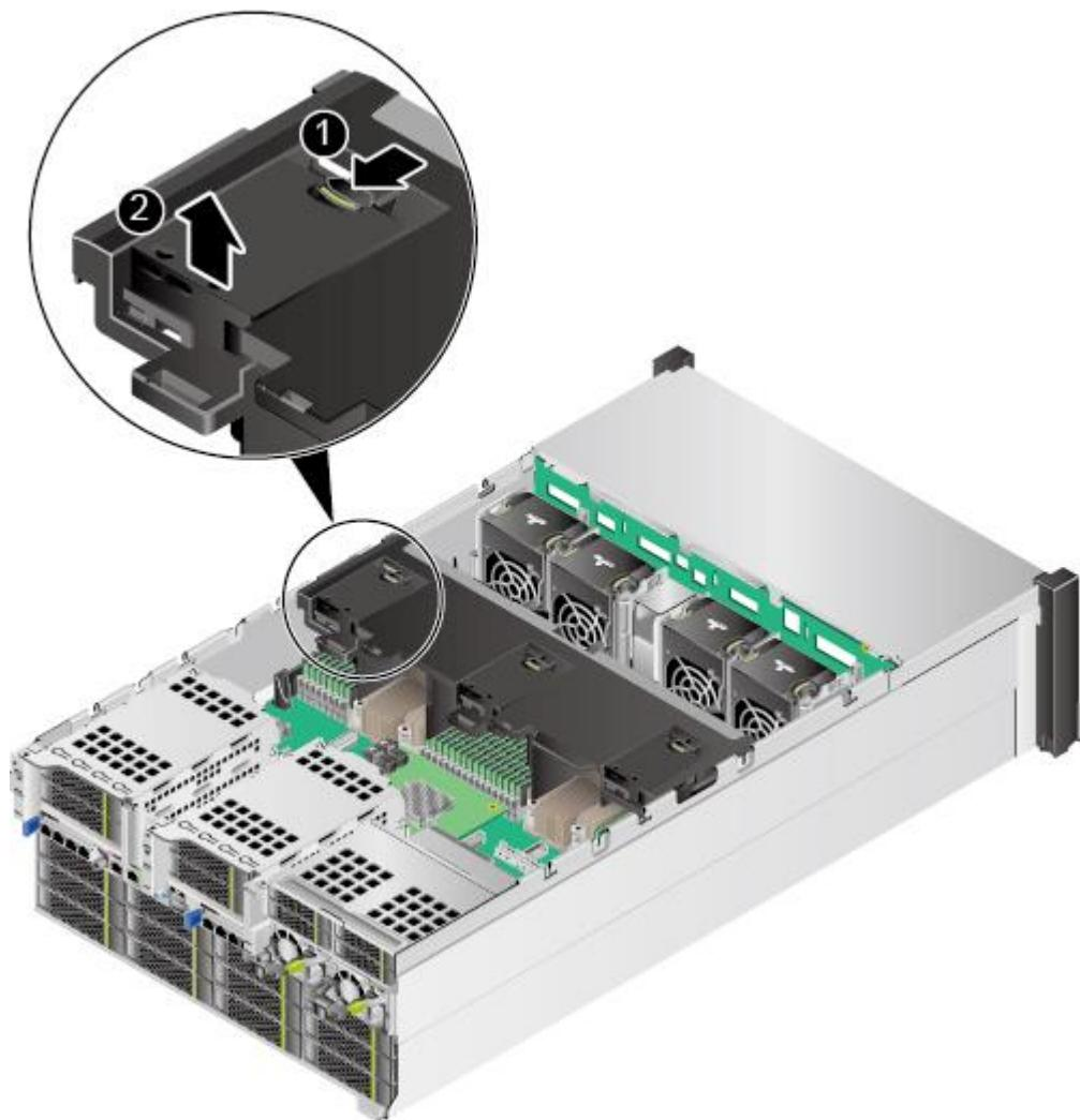
步骤 8 沿水平方向掰开固定超级电容的塑料卡扣，如图 5-120 中①所示。
