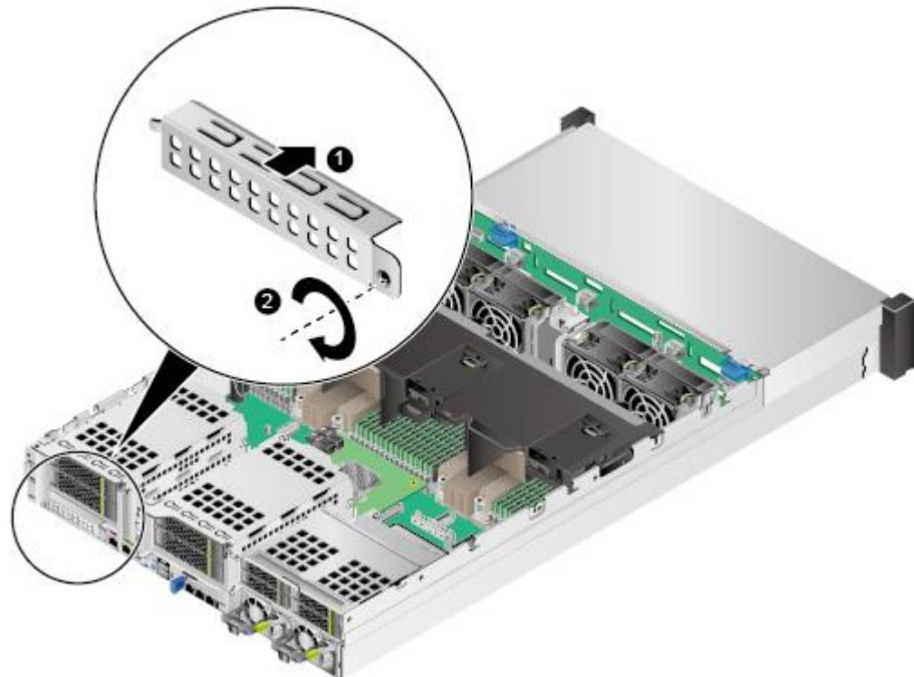
图5-131 36x3.5 英寸硬盘机箱安装灵活 IO 卡空闲挡板
