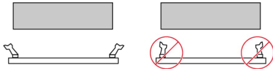
步骤 9 将 DIMM 的缺口与插槽导轨上的凸起对齐，并插入 DIMM 插槽中，如图 5-127 所示。
