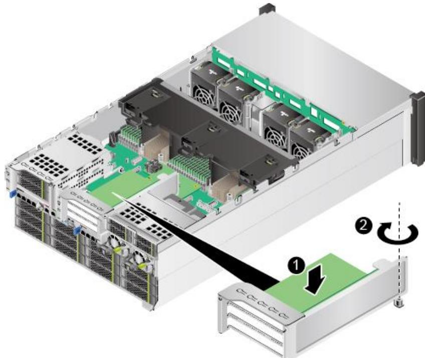
步骤 10 安装 Riser 模组 3 时，需要先安装 Riser 模组下托架，如步骤 10 所示，将下托架固定好之后，向下放入 Riser 模组上托架，并拧紧支架的固定螺钉，如 0 所示。
