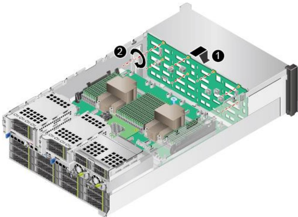
步骤 4 拧紧前置硬盘背板的固定螺钉，如图 5-140 中②所示。
