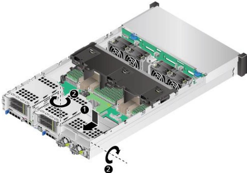
图5-157 36x3.5 英寸硬盘机箱安装后置硬盘组件
