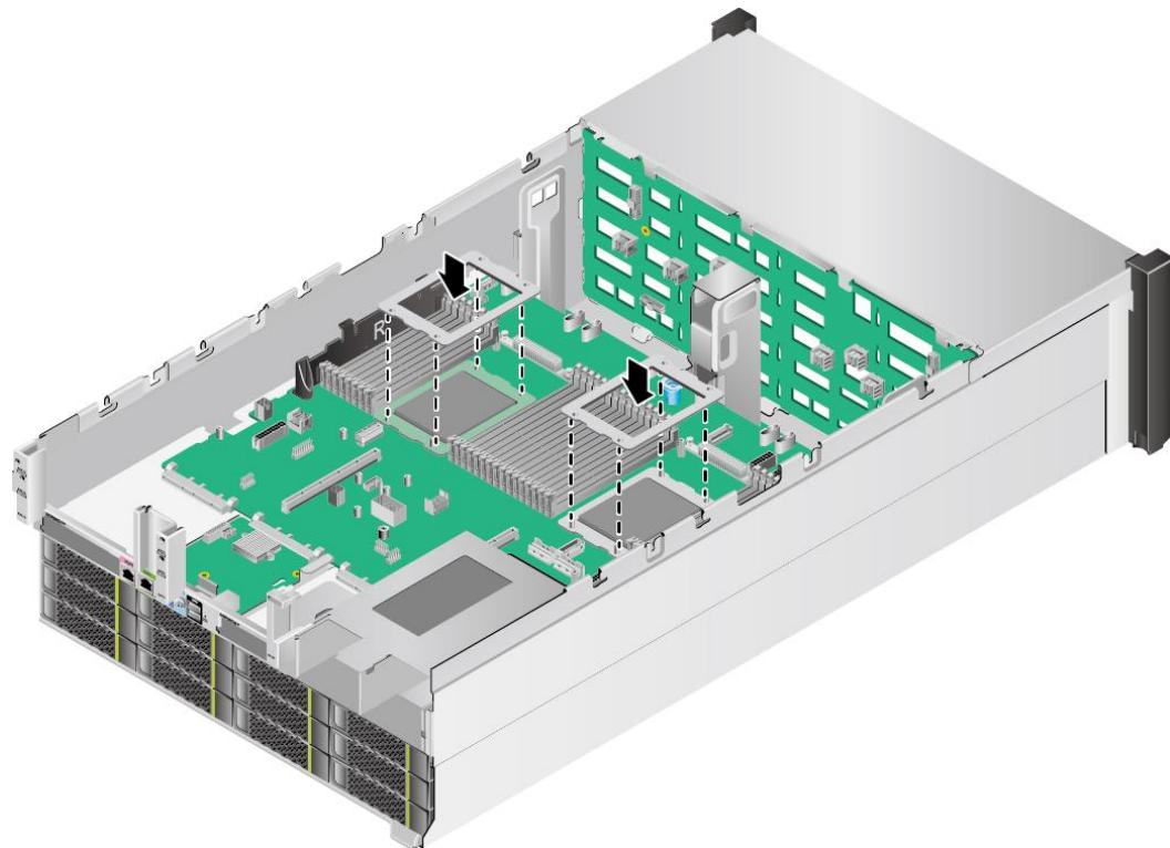
步骤 9 向下安装 CPU 散热器，用十字螺丝刀拧紧固定在散热器上的四颗螺钉。
