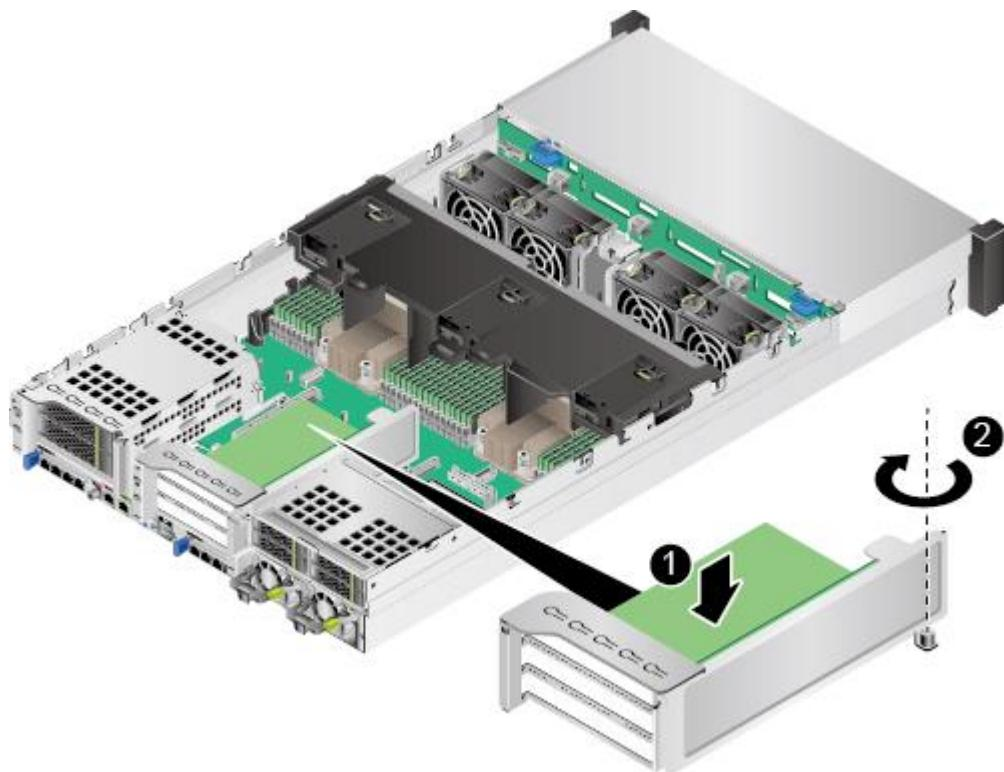
图5-94 36x3.5 英寸硬盘机箱安装 Riser 模组 2
