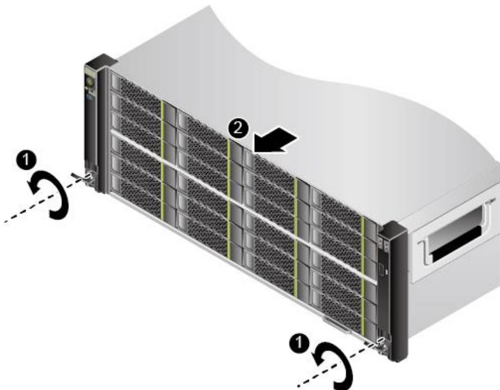
2. 如图 5-16 中②所示，沿滑轨向远离机柜的方向缓慢拉出服务器。
