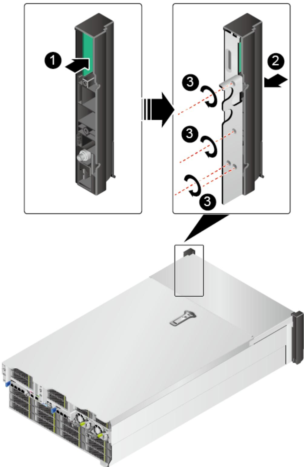
步骤 8 安装右挂耳，并使用螺丝刀拧紧右挂耳固定螺钉，如图 5-175 中②和③所示。
