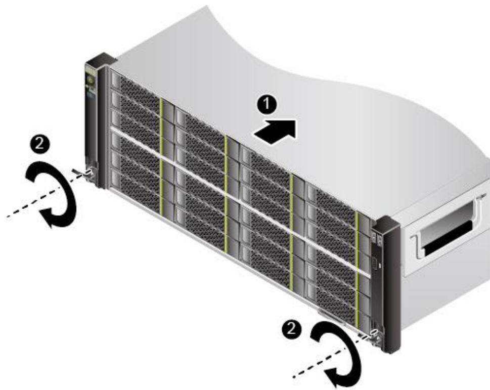
3. 如图 5-8 中②所示，将服务器两侧挂耳紧贴方孔条，按顺时针方向拧紧挂耳上的松不脱螺钉，固定服务器。
