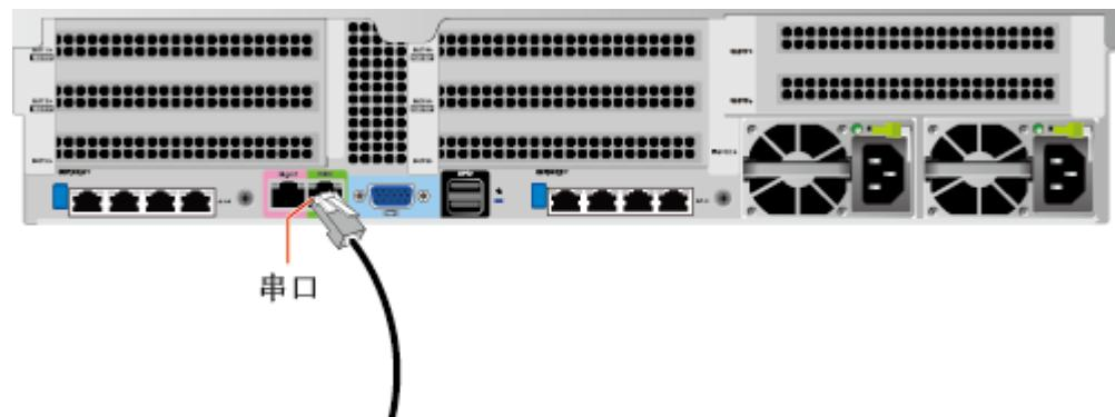
图5-25 36x3.5 英寸硬盘机箱连接串口线缆
