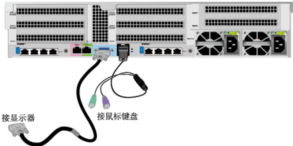
图5-16 36x3.5 英寸硬盘机箱连接 USB 转 PS2 线缆和 VGA 接口
