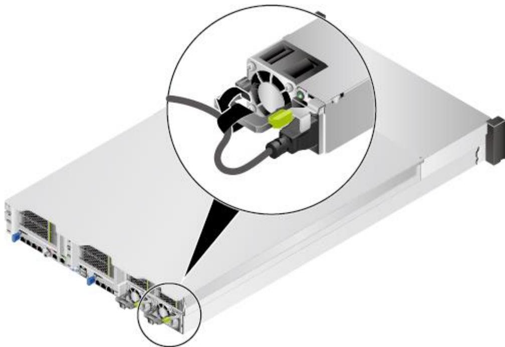
图5-29 36x3.5 英寸硬盘机箱固定电源线缆
