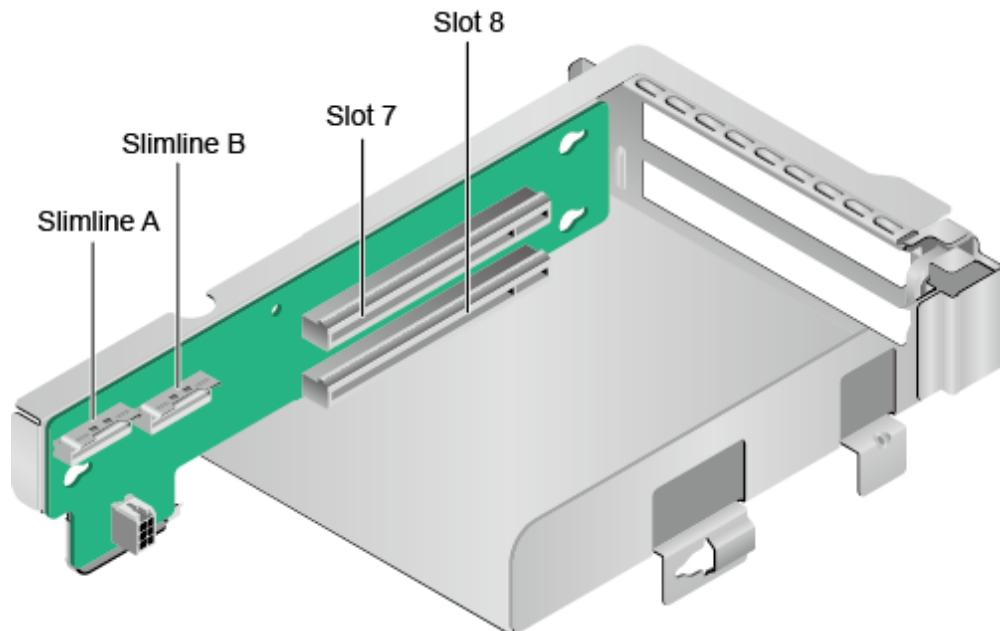
当图 2-24 中 Riser 卡安装在 IO 模组 3 时，PCIe 槽位为 Slot 8。
