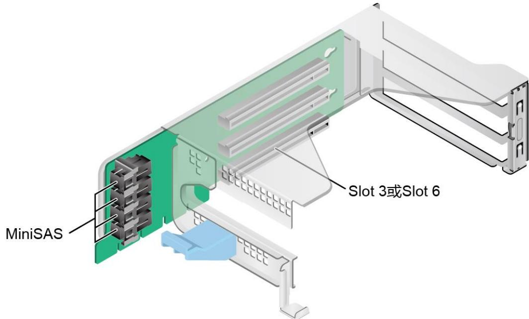
IO 模组 3 支持的 Riser 卡如图 2-23 和图 2-24 所示。
