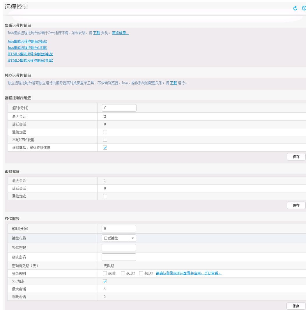
**步骤 3** 单击“Java 集成远程虚拟控制台(独占)”、“Java 集成远程虚拟控制台(共享)”、“HTML5 集成远程控制台(独占)”或“HTML5 集成远程控制台(共享)”，进入服务器的实时操作控制台，如图 8-2 或图 8-3 所示。
