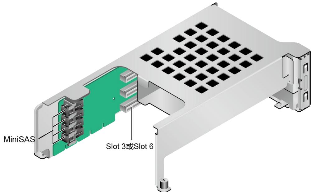
IO 模组 3 支持的 Riser 卡如图 3-25 和图 3-26 所示。
