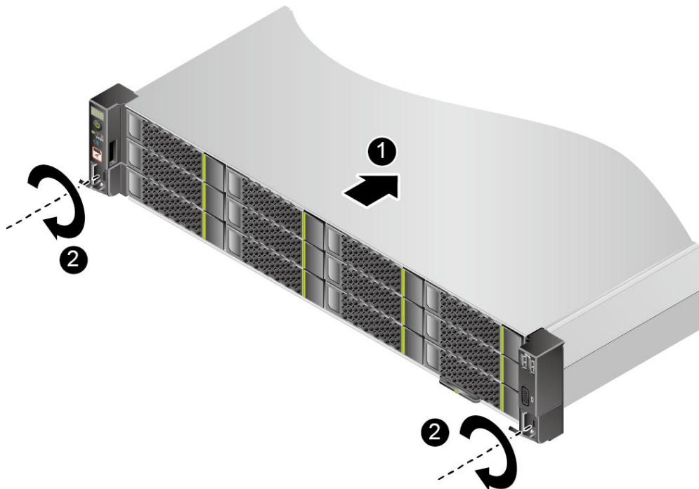
3. 如图 6-9 中②所示，将服务器两侧挂耳紧贴方孔条，按顺时针方向拧紧挂耳上的松不脱螺钉，固定服务器。
